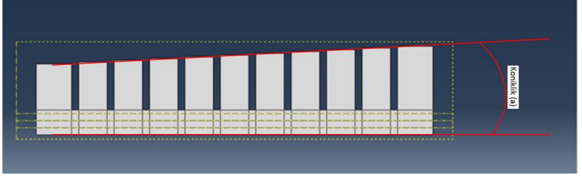
Şekil 5. 6 Parça üzerindeki koniklik
