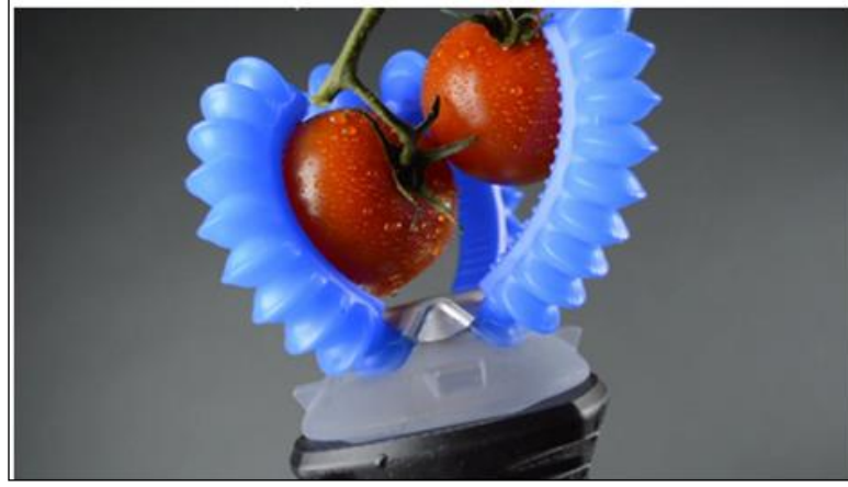
Şekil 4. 4 Yumuşak cisimleri zarar vermeden kavraya bilen robot kol[38]
