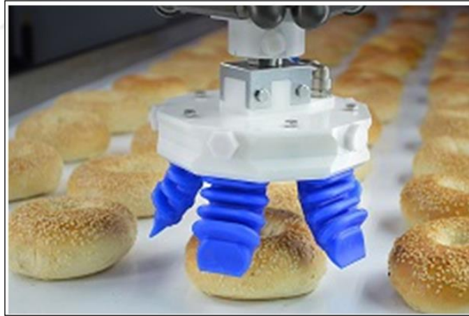
Şekil 4. 3 Delta robot kolu ucuna monte edilmiş yumuşak tutucu [37]
