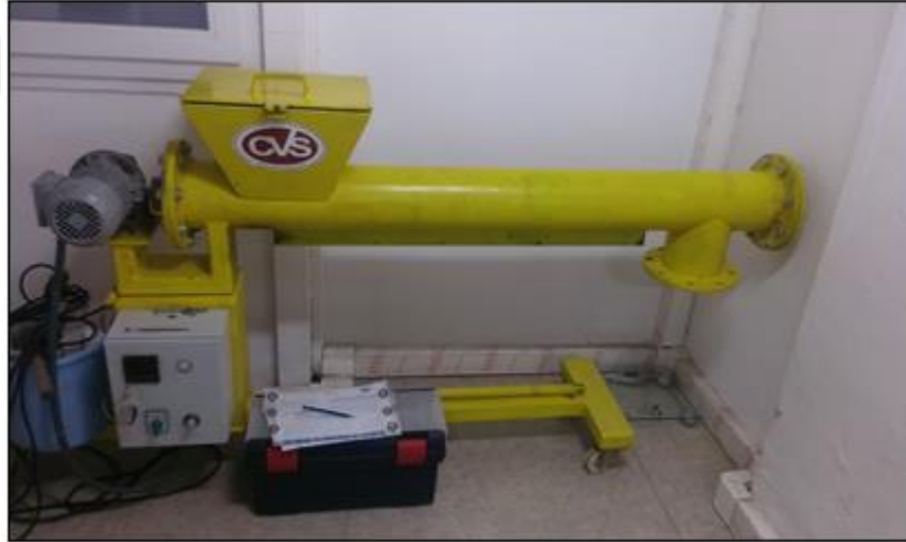
Şekil 2.3 YTU konstrüksiyon laboratuvarında ki helezon konveyör sistemi
