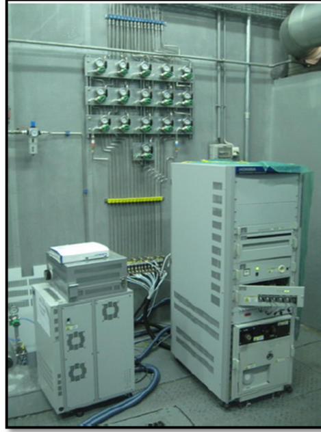
Şekil 2.2 Horiba Mexa 7100 DEGR egzoz emisyon ölçüm cihazı
