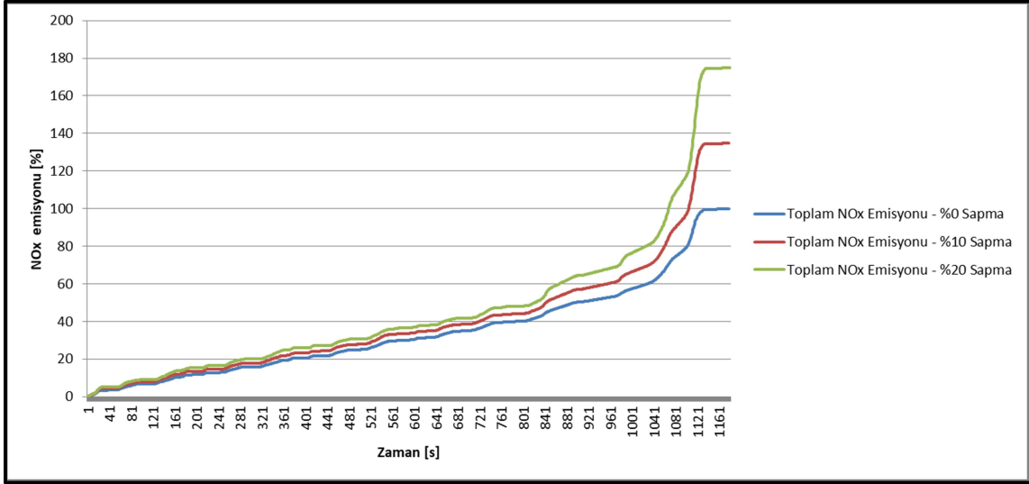
Şekil 3.77 İdeal durum, %10 sapma ve %20 sapma durumlarında normalleştirilmiş toplam NOx emisyonlarının karşılaştırılması
