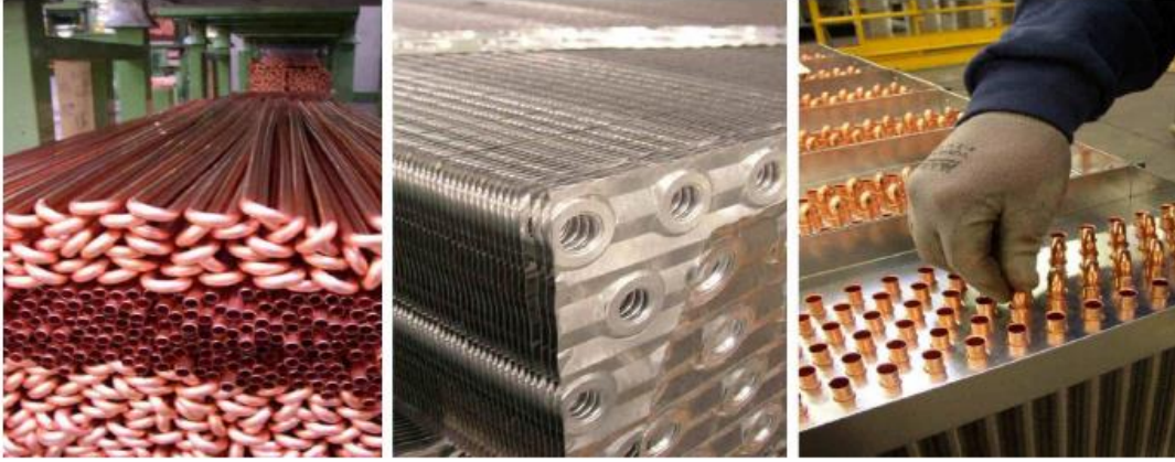
Şekil 2. 4 Batarya temel bileşenleri: boru, kanat ve kurve dizilişleri [19]
