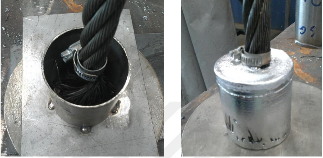
Şekil 7. 7 D numunesi kalıbı ve dökülmüş numune
