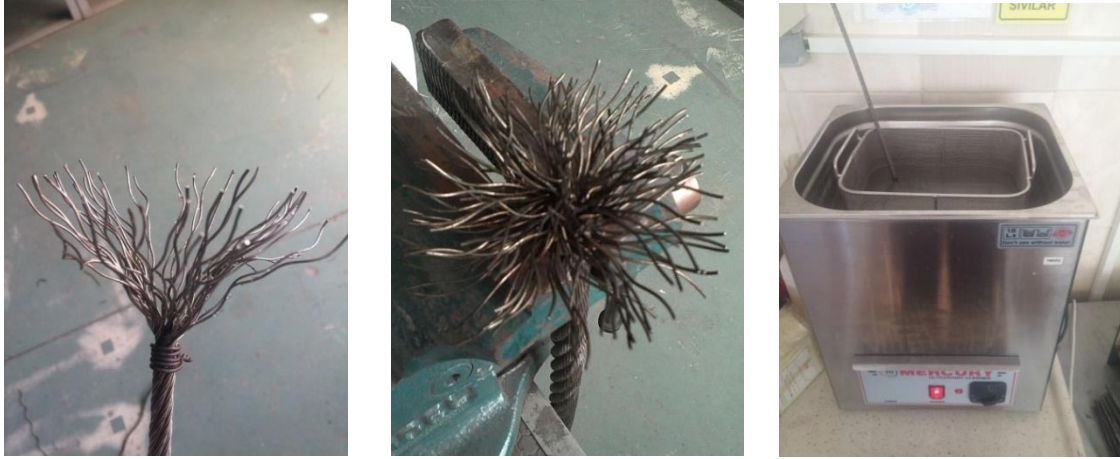
Şekil 7. 5 Halat ucu hazırlanması ve ultrasonik temizlik işlemi
