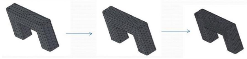
Şekil 5. 1 Sonlu elemanlara ayrılmış model
