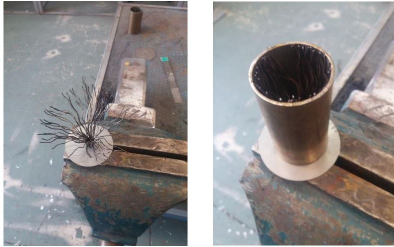
Şekil 7. 8 Delikli parça ve kullanılan kalıp
