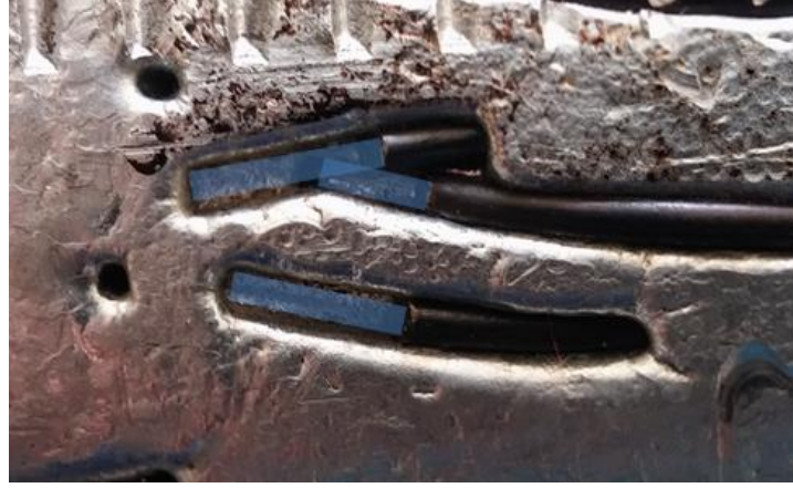
Şekil 7. 13 D numunesi tel kayması
