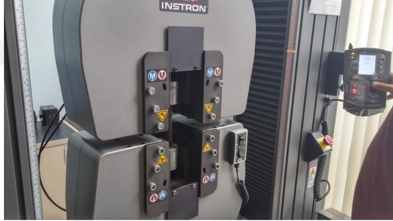
Şekil 7. 12 D numunesi çekme işlemi
