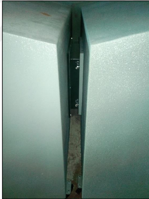
Şekil 4.7 Ses iletim kaybı ölçümleri için birleştirilmiş kabinler
