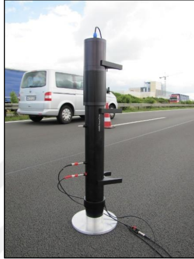
Şekil 2.12 Açık uçlu empedans tüpü ile yerinde ses yutum ölçümü
