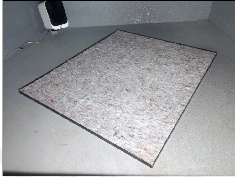
Şekil 4.3 Numunenin, numune çerçevesine ve oda tabanına yerleştirilmesi
