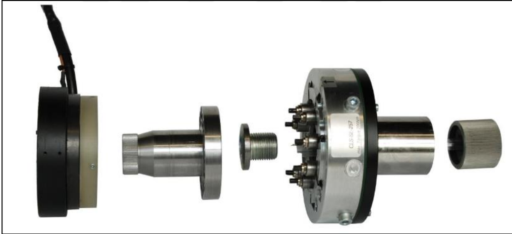
Şekil 3. 8 Soldan Sağa doğru : Açı ölçer, Direksiyon simidi adaptörü, Cıvata, Tork Sensörü, Direksiyon kolunu adaptörü [18]
