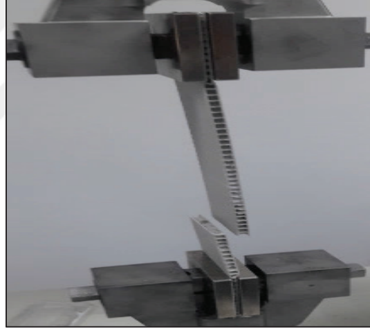
Şekil 8. 2 %5 Masterbatch takviyeli petek yapılı PP sandviç panel test numunesinde deney sonucunda meydana gelen kırılma
