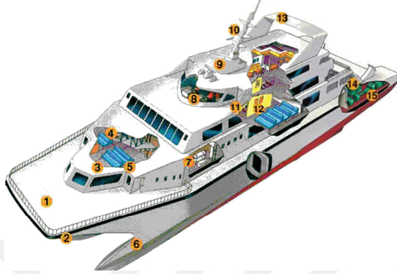
Şekil 6. 11 Teknede kullanılan petek yapılı kompozitler (2 ve 6 : Dış gövde kısmı, 4 : Asma tavanlar, 7 : Kamara bölmeleri, 9 : Hava kalkanı) [6]
