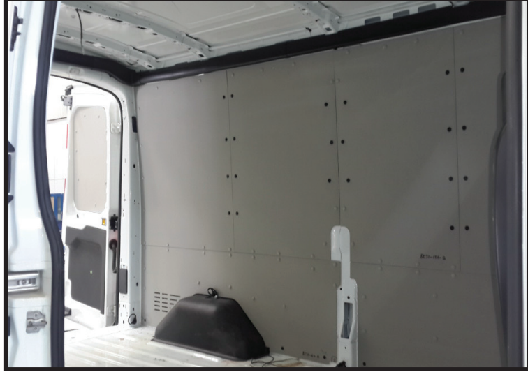
Şekil 8. 15 Petek yapılı polipropilen sandviç panele sahip hafif ticari araç gövde yan paneli
