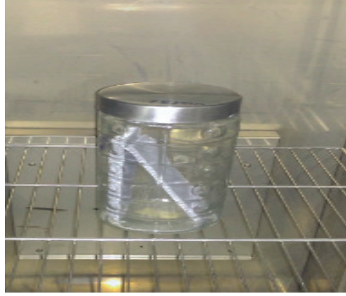
Şekil 7. 5 Koku deneyini gerçekleştirmek üzere 40°C'ye ısıtılan fırın içerisine yerleştirilmiş test numuneleri
