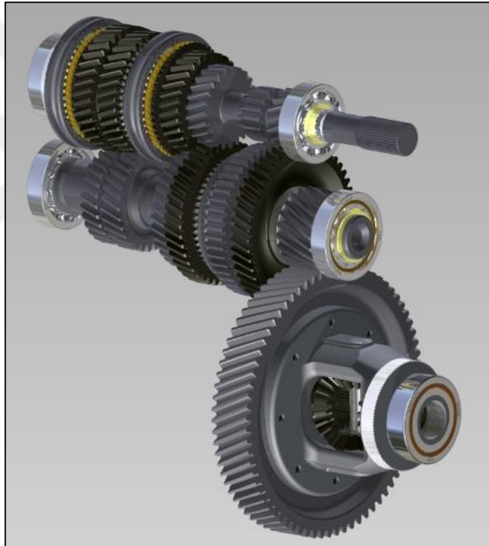
řekil 2. 2 Beř hızlı bir araca ait helisel diřlilerden oluřan manuel řanzıman [9]
