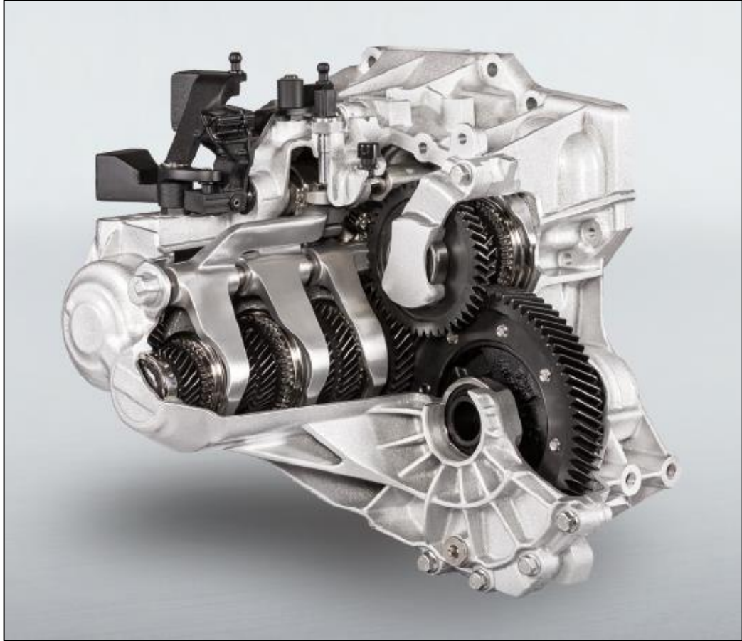
Şekil 2. 1 Getrag altı hızlı şanzıman[8]
