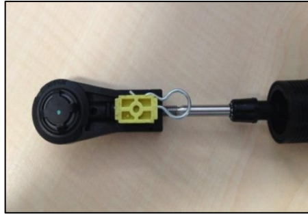
Şekil 2. 11 Seçme halatı ayar mekanizması
