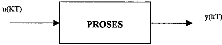
Şekil 5.1 Tek giriş ve tek çıkışlı proses blok diyagramı
