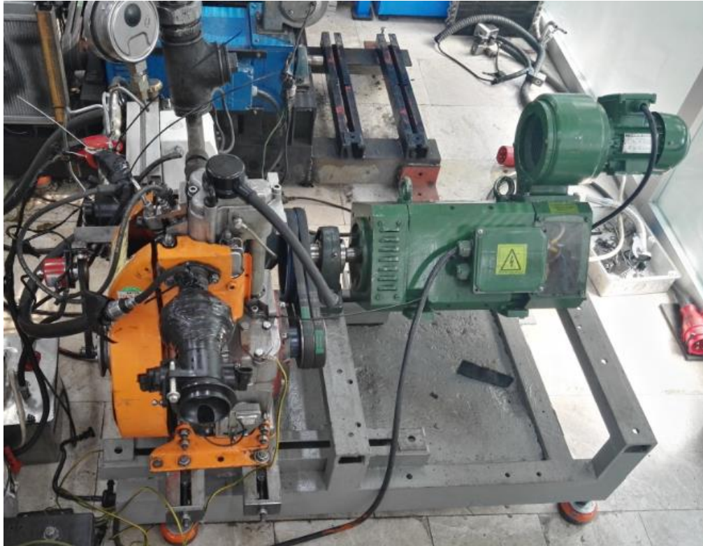
Şekil 4.1 PLC kontrollü yüksek basınç püskürtmeli Lombardini LDA450 motor seti
