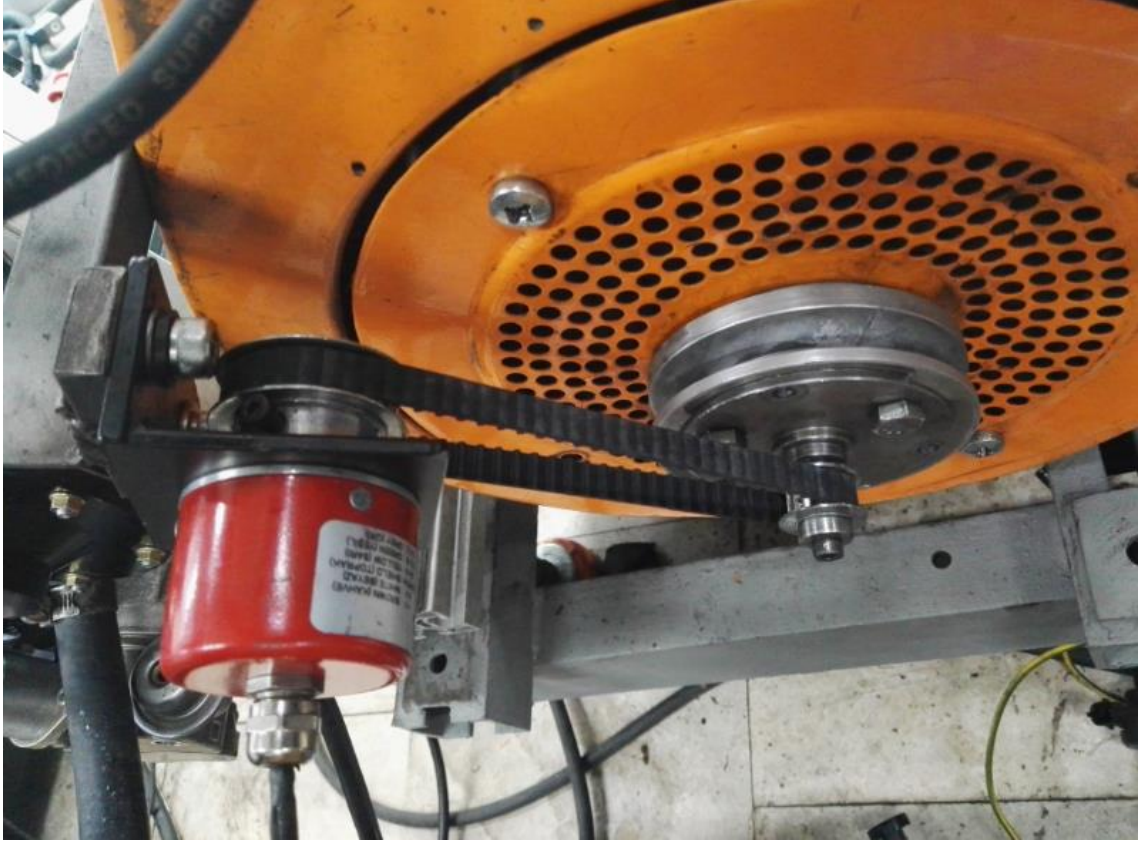
Şekil 4.8 DC motor ve enkoderin test motoruna bağlantısı
