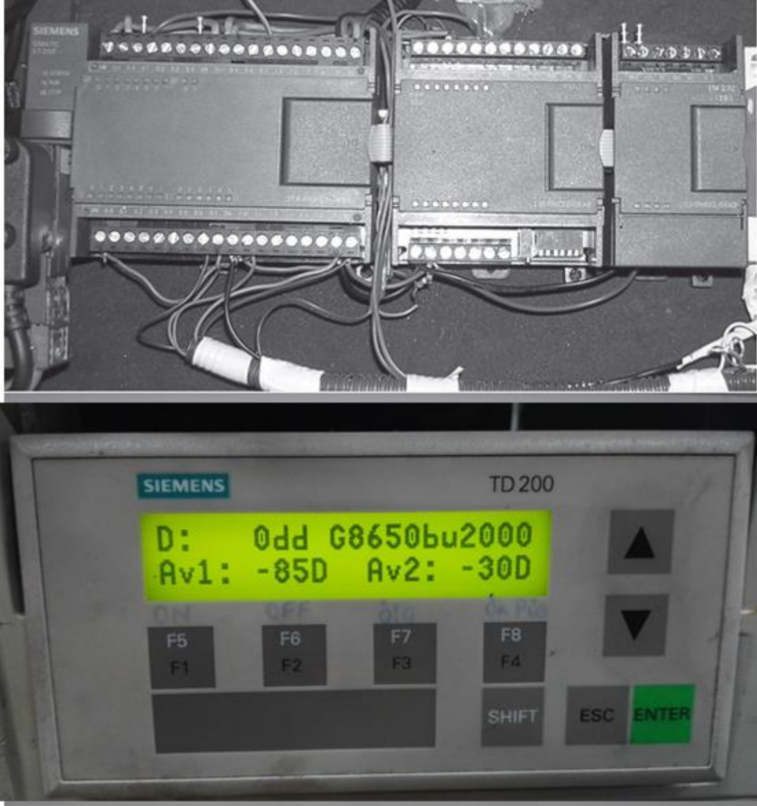
Şekil 4. 16 Siemens S7-200 CPU-224 PLC, EM-231 ADC ve TD200 HM ekranı
