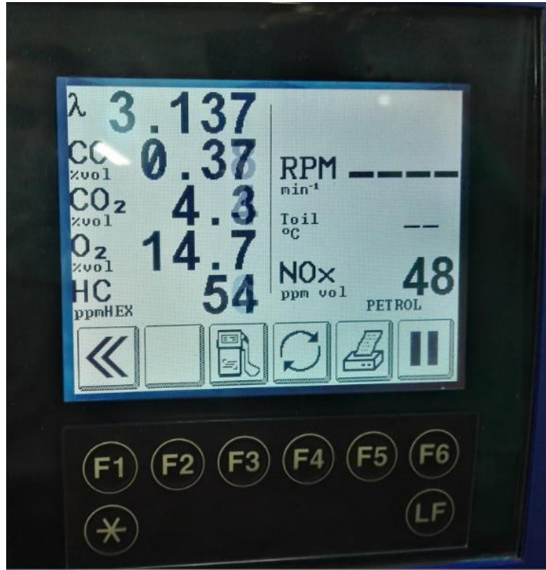
Şekil 4. 14 AVL Egzoz emisyon ölçüm cihazının ekranı
