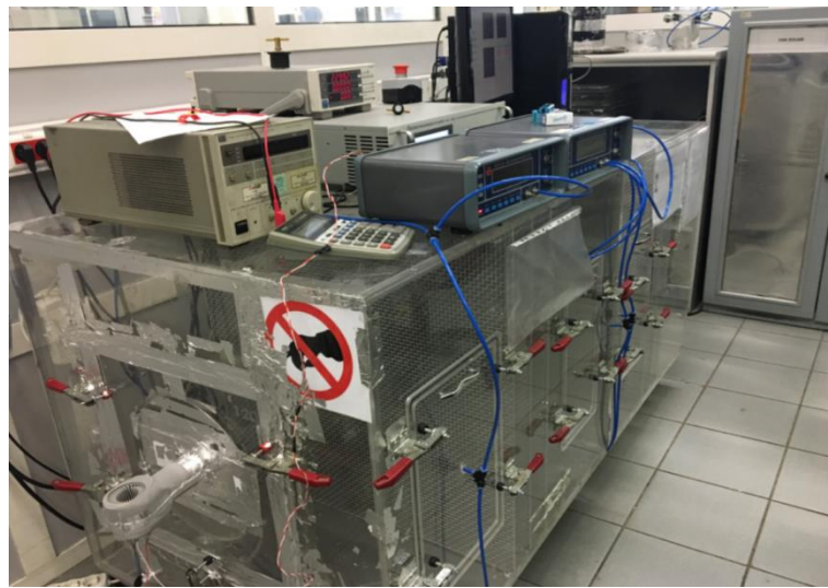
Şekil 4. 2 Debi ölçümünde kullanılan rüzgar tüneli
