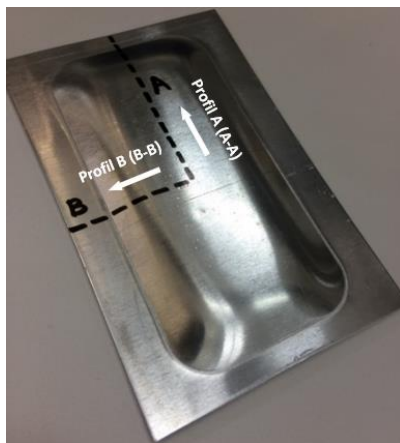
Şekil 3.6 Parça üzerindeki A-A ve B-B kesitleri
