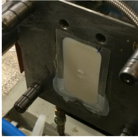
Şekil 4.4 Yüksek enjeksiyon hızı sebebiyle meydana gelen çapak oluşumu
