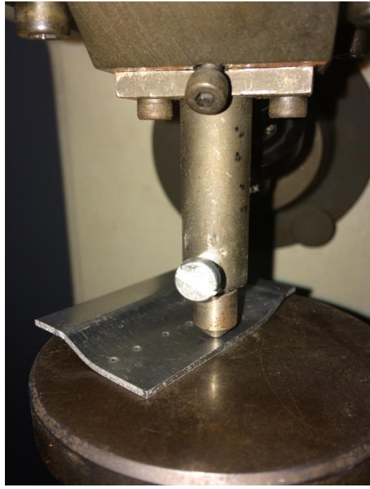
Şekil 3.7 Rockwell sertlik ölçme yöntemi
