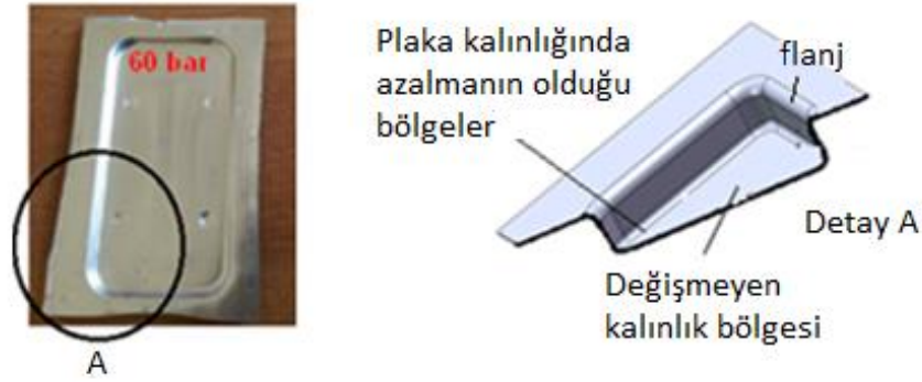
Şekil 4.2 Parça üzerindeki kalınlık değişimleri
