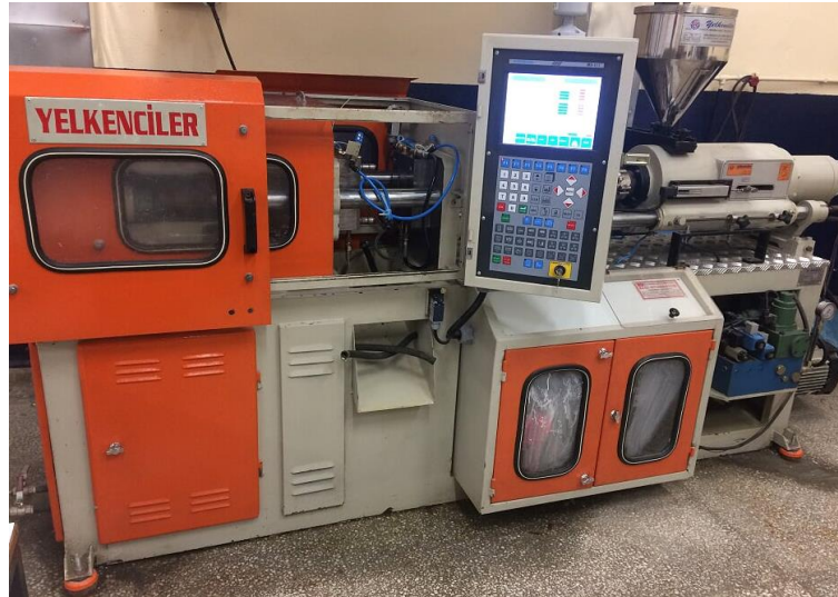
Şekil 3.5 Deneysel çalışmada kullanılan plastik enjeksiyon makinesi
