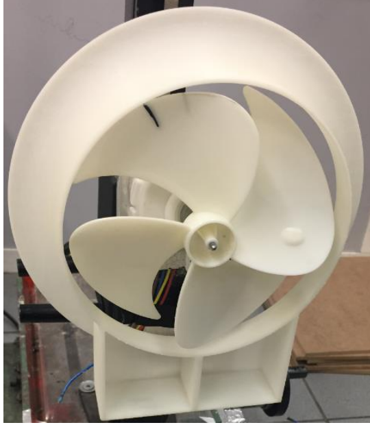
Şekil 6. 2 SLA'dan yapılmış hava yönlendirici prototipi
