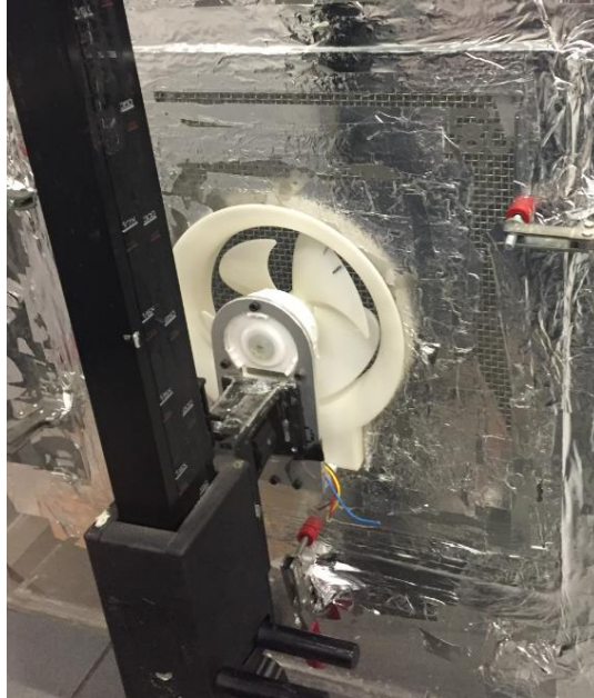
Şekil 6. 3 Hava yönlendirici ve fanın debi ölçüm düzeneğindeki yerleşimi
