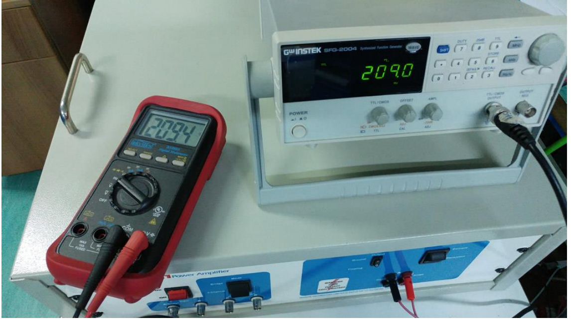
Şekil 5. 13 Sinyal üretici (209 Hz frekansta sinyal ürettiği an)
