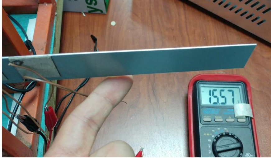
Şekil 5. 3 Mekanik zorlama ile oluşan gerilim (15.5 Volt)
