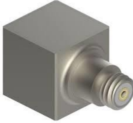
Şekil 6.3 Deneyde kullanılan ivmeölçer
