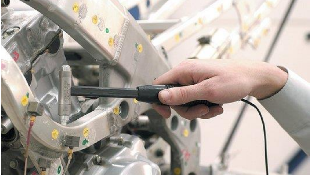
Şekil 4.3 Modal analizi yapılan bir sistemden ölçümlerin alınması
