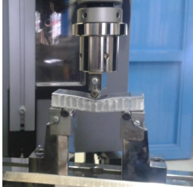
Şekil 3. 5 Hazırlanmış olan bal peteği çekirdekli sandviç yapının eğme testi
