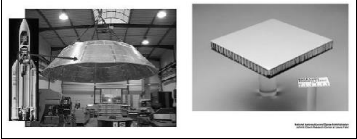
Şekil 2. 12 Sandviç köpük panelden (AFS) yapılmış Ariane5 roket konisi
