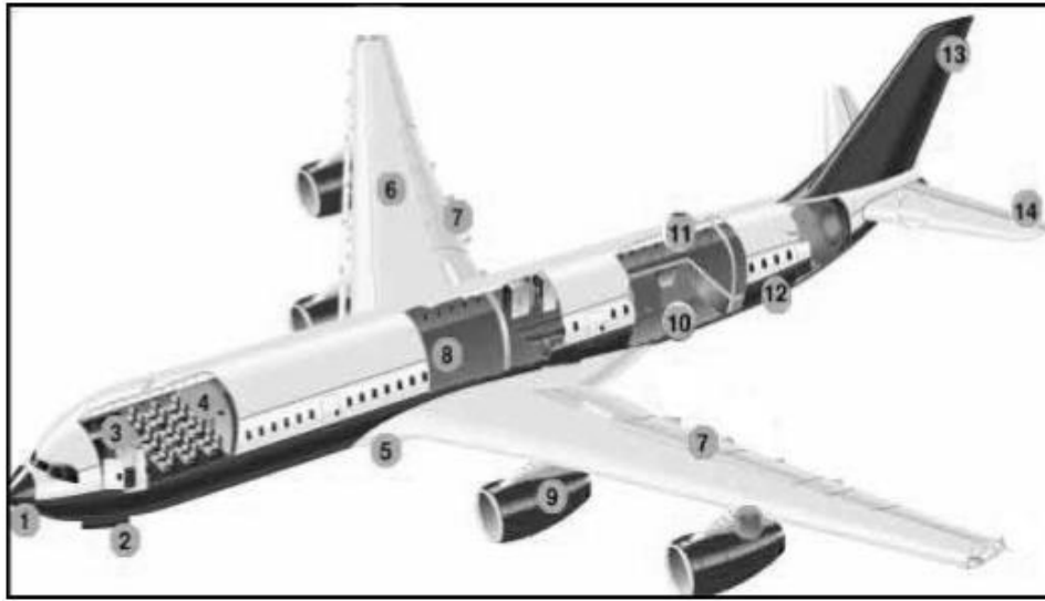
Şekil 2. 7 Ticari bir uçakta sandviç yapı kullanılan bölümler [8]
