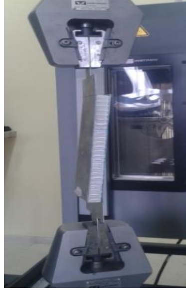
Şekil 3. 6 Hazırlanmış olan bal peteği çekirdekli sandviç yapının çekme testi
