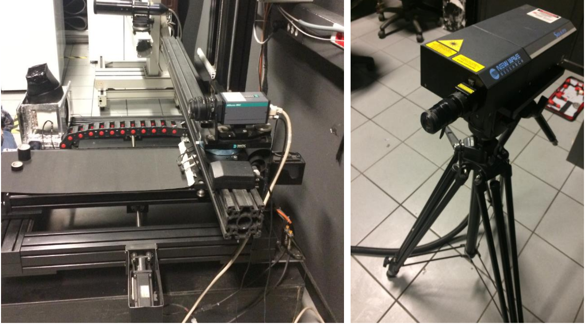
Şekil 7.4 Yüksek hızlı kamera ve lazer
