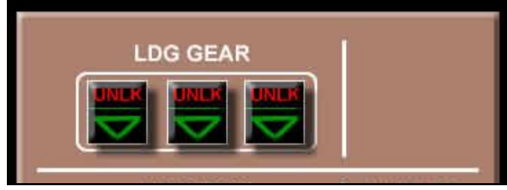
Şekil 2. 8 Airbus A320 uçağına ait iniş takımı göstergesi [19]
