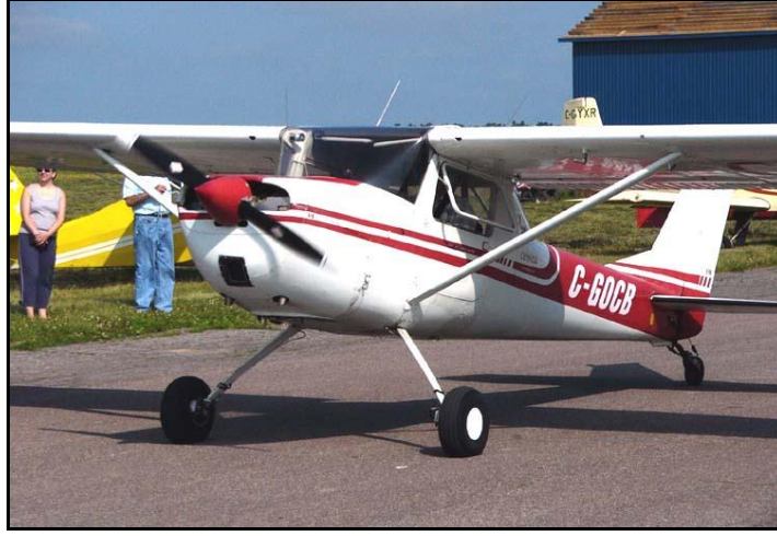
Şekil 2. 1 Kuyruk iniş takımı örneği (Tailwheel landing gear) [12]
