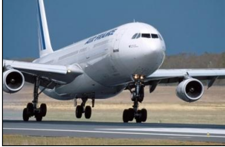
Şekil 2. 5 Destek dikmesine bir örnek (Center landing gear) [16]
