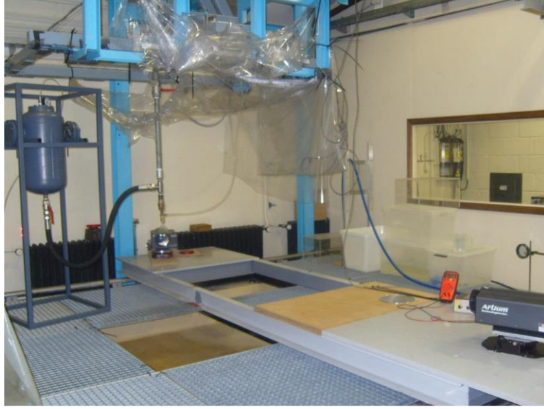
Şekil 2. 62 Damlacık çapı ve hızının ölçülmesi için kullanılan deney düzeneği [50]
