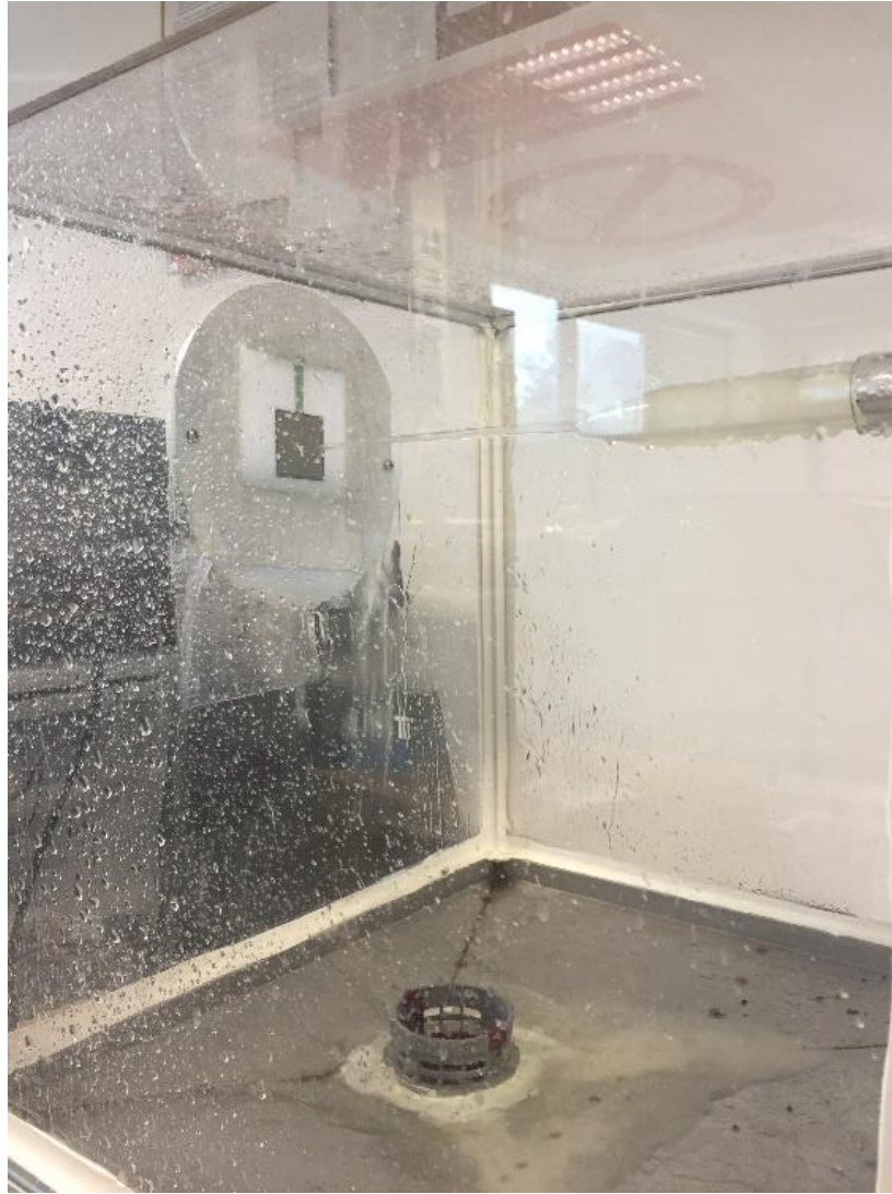
Şekil 5. 8 Kuvvet ölçüm deneyinde jetin etki yüzeyine çarpması
