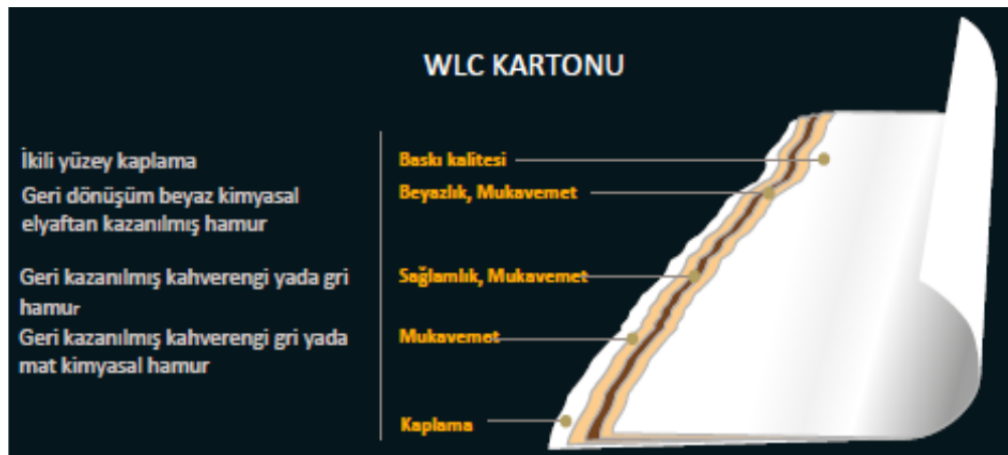
Şekil 5. 3 WLC kartonu katmanları [stora enso]
