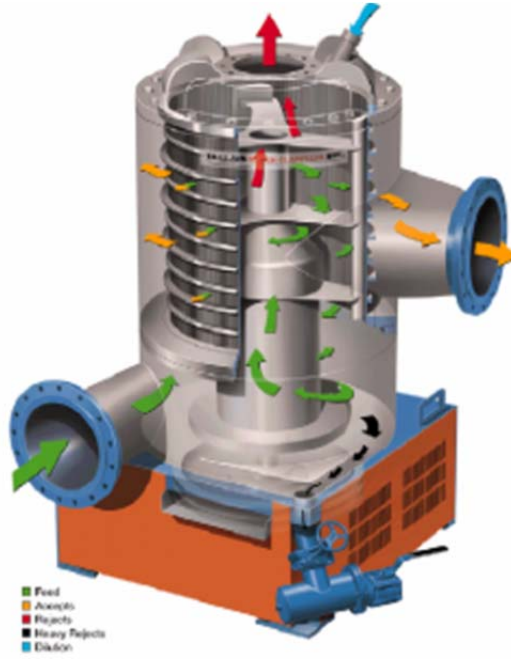
Şekil 6. 5 Basınçlı elek
