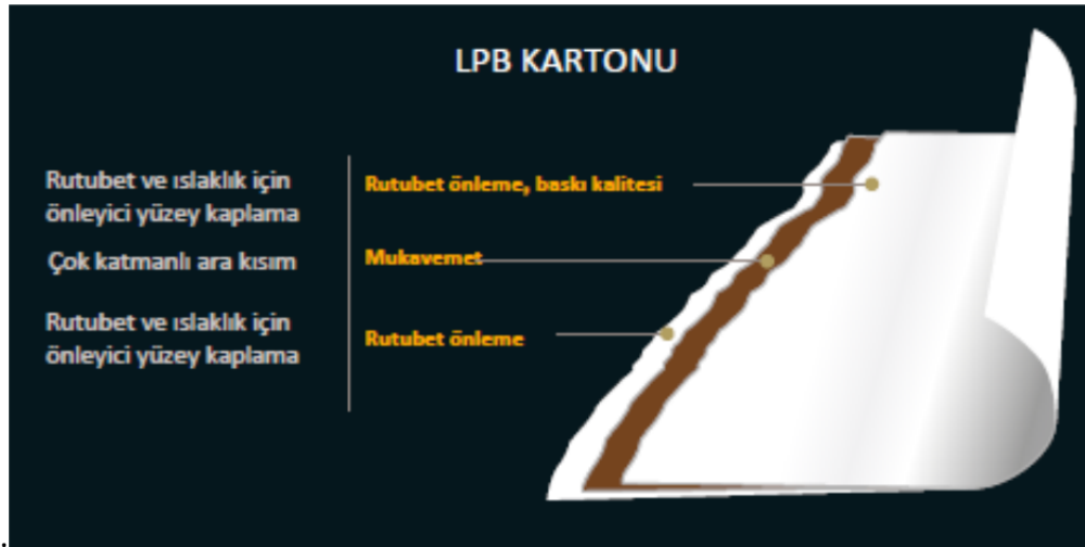
Şekil 5.5 LPB kartonu katmanları [stora enso]
