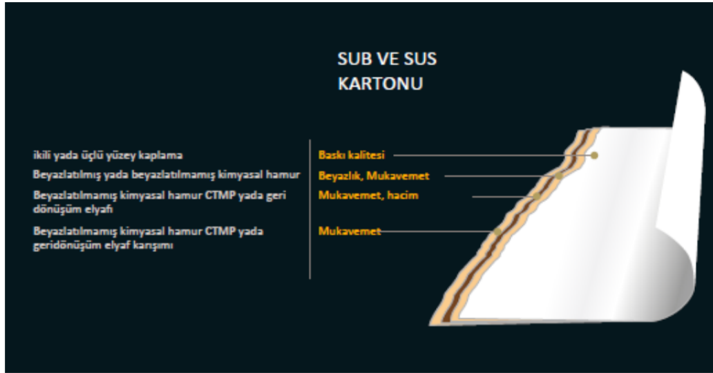
Şekil 5. 2 Sub ve sus kartonu katmanları [stora enso]
