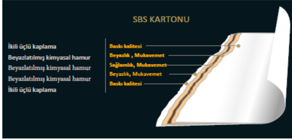
Şekil 5. 6 SBS kartonu katmanları [stora enso]
