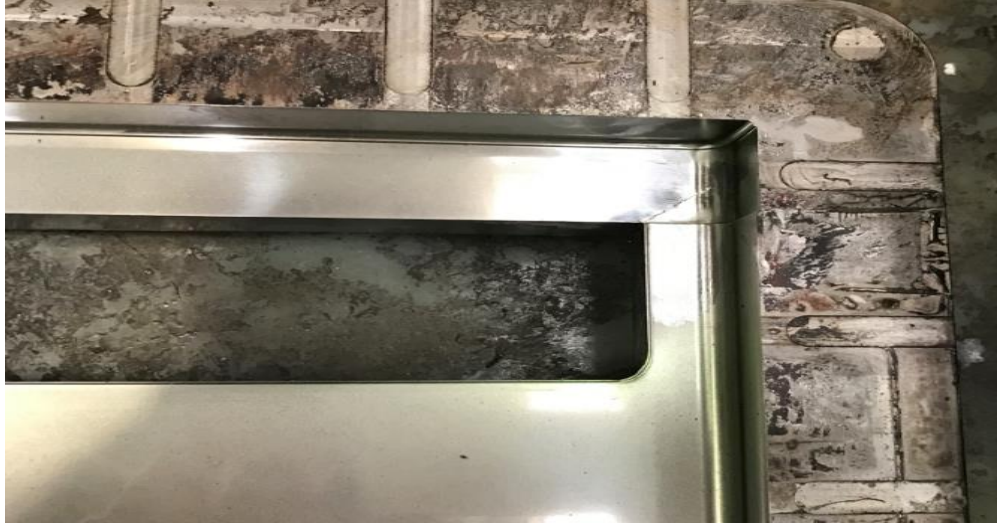
Şekil 4.2 Darbeye bağlı olarak çatlamış dişi kalıp çekirdeği
