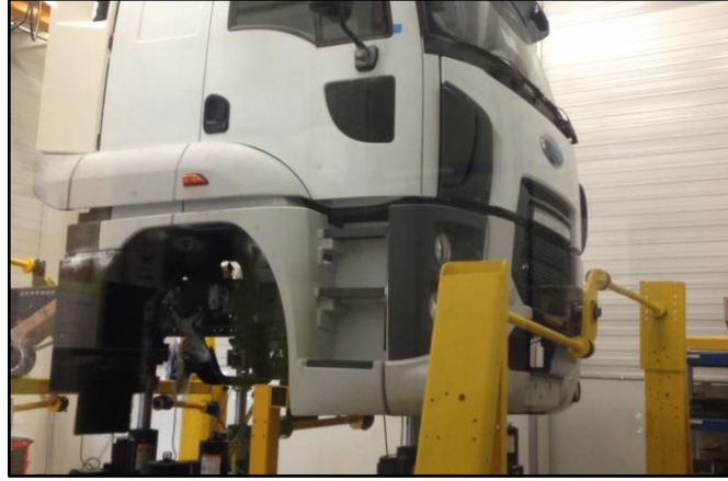
Şekil 2.10 Fourposter test düzeneğindeki kabin
