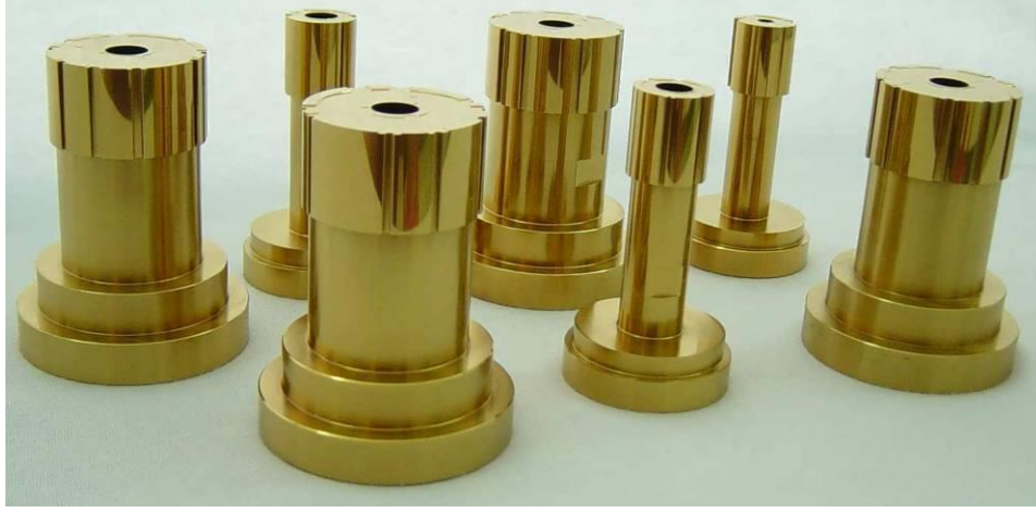
Şekil 3. 16 Katodik ark yöntemi ile kaplanmış TiN zimbalar [35]
