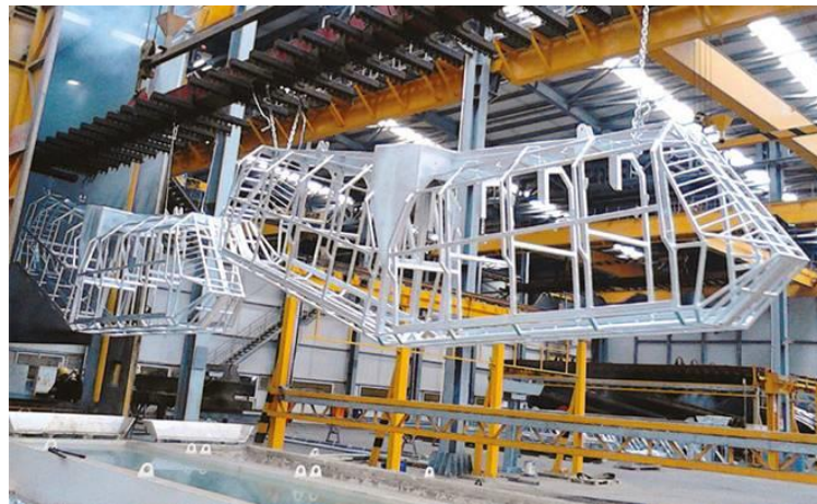
Şekil 3. 3 Sıcak daldırma galvaniz uygulaması [25]
