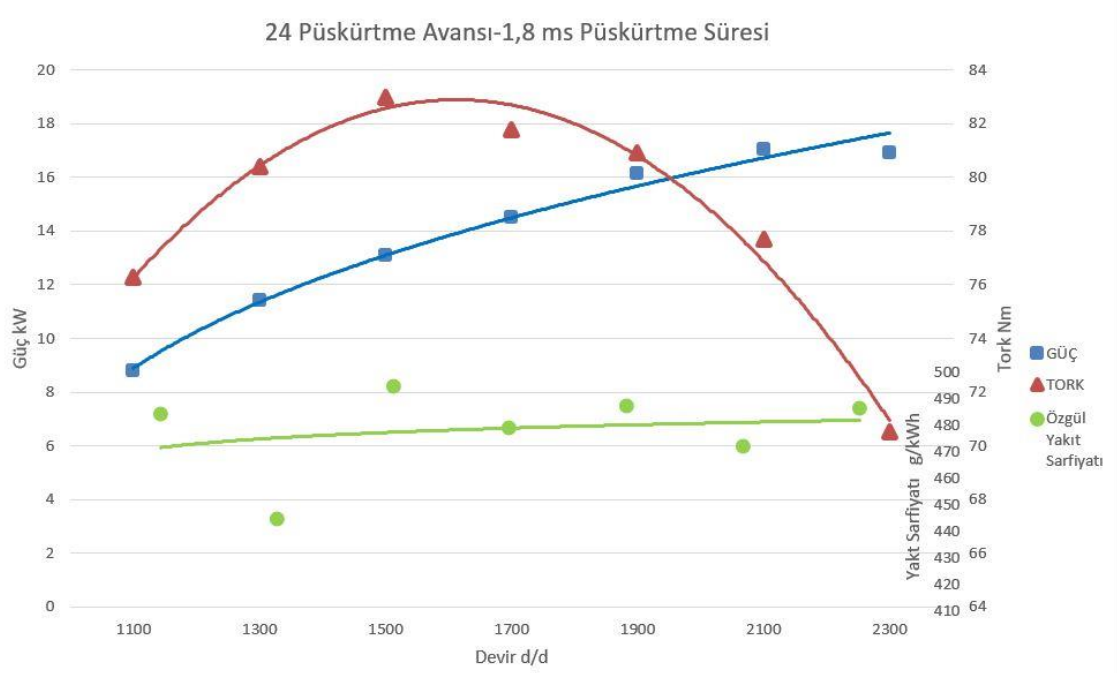
Şekil 5-33 24°KMA Püskürtme avansı-1,8 ms püskürtme süresi için performans grafiği
