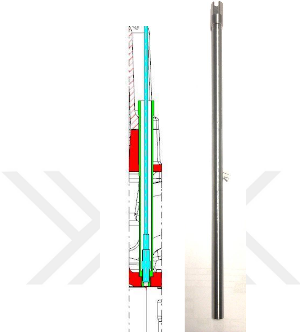
Şekil 4-15 Basınç sensörünün kafa konumu ve özel anahtarı
