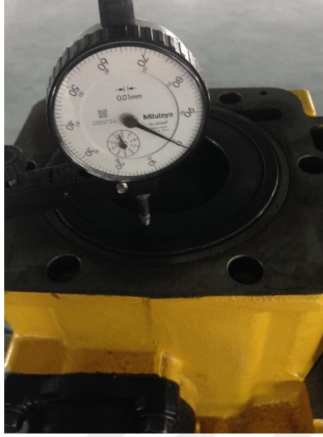
Şekil 4-17 Üst ölü nokta belirlenmesi
