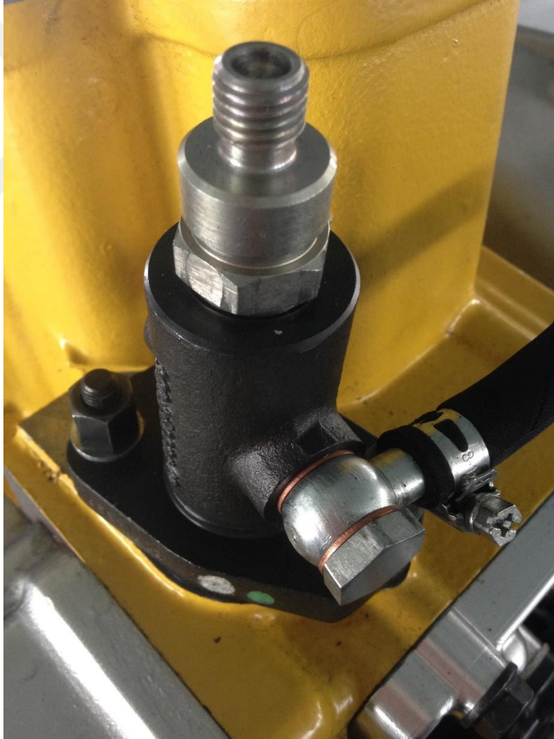
Şekil 3-4 Test motoru pompasının bağlantı şekli
