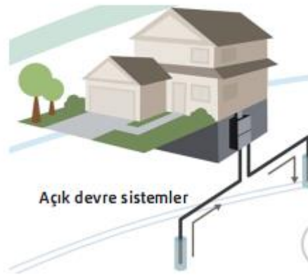
Şekil 2.4 Açık Çevrimli Toprak Kaynaklı Isı Değıřtiricisi Örneğı [63]
