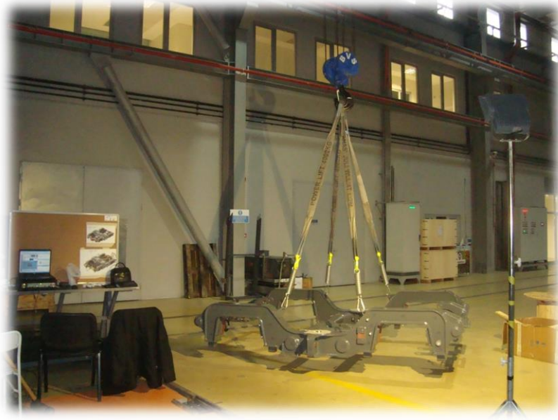
Şekil 4. 9 Boji şasisinin yay ve halatlar ile kren kancasına asılması
