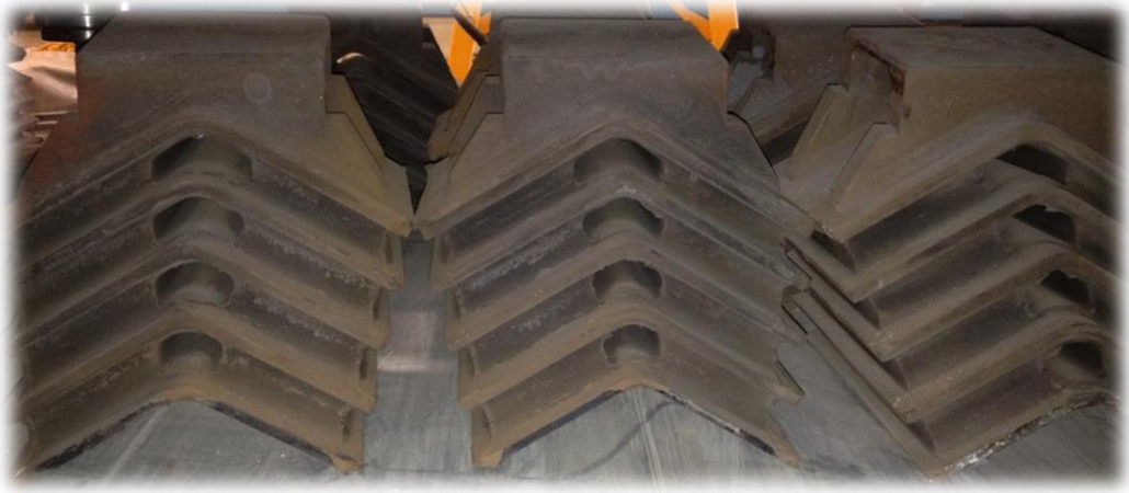
Şekil 3. 5 Birincil süspansiyon olarak kullanılan şevronlar
