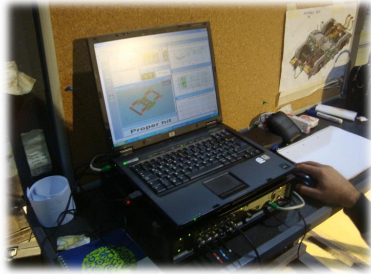
Şekil 4. 2 PULSE type 3560C-E01-titreşim analiz cihazı ve ekipmanları
