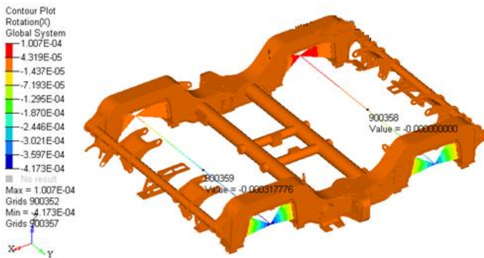
Şekil 6. 4 Burulma hesabı için sınır şartları
