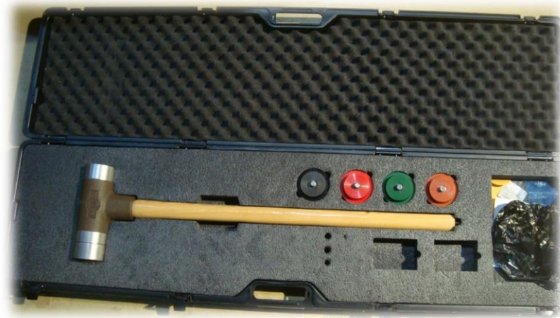
Şekil 4. 4 B&K 8210 kodlu darbe çekici ve çekiç başlık tipleri
