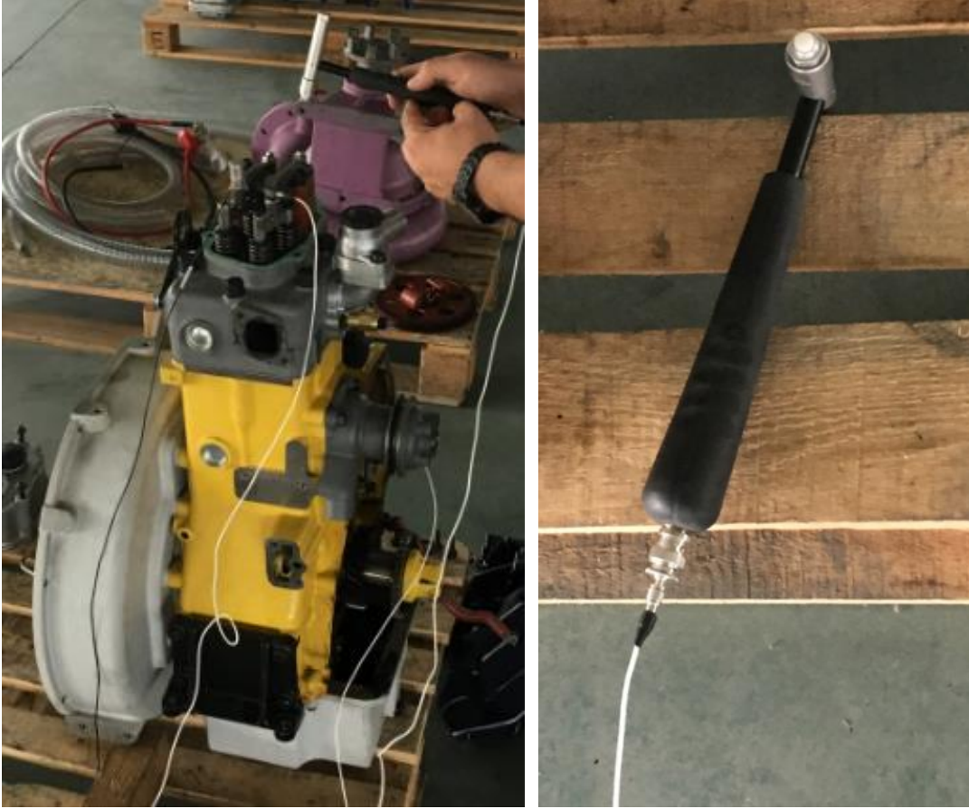
Şekil 4.4 Çekiç-Titreşim Testi Giriş Titreşim Sinyalinin Çekiç Vasıtasıyla Eldesi
