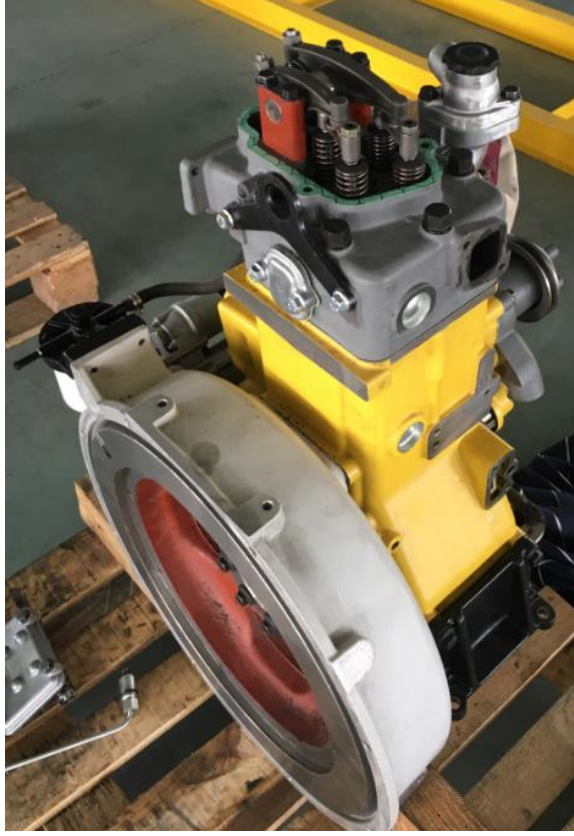
Şekil 4.1 Çekiç-Titreşim Testi Gerçekleştirilen Motor
