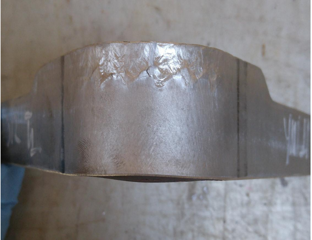
Şekil 7.36 Eğme testi sonucu ön tavlı II nolu numune
