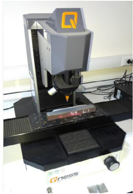
Şekil 7.26 Universal sertlik cihazı
