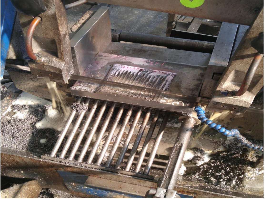
Şekil 7.21 Bir nolu plakadan makro inceleme numunesi elde edilmesi
