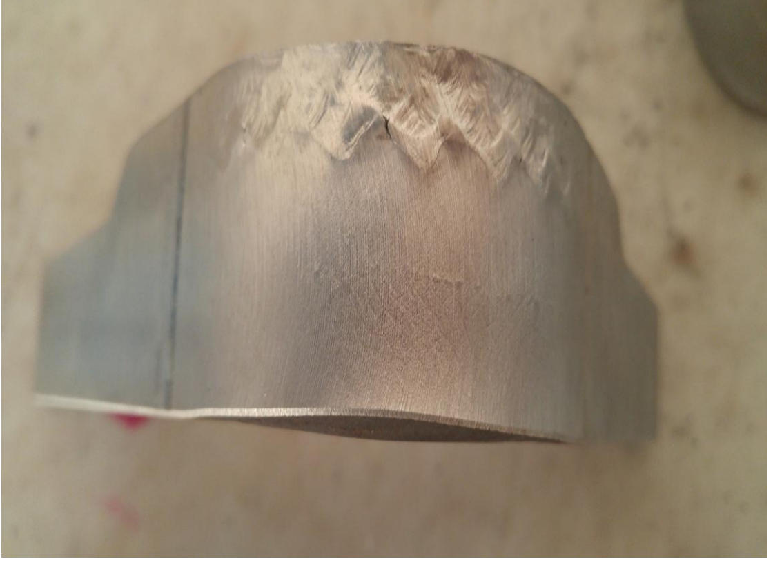
Şekil 7.35 Eğme testi sonucu ön tavlı I nolu numune
