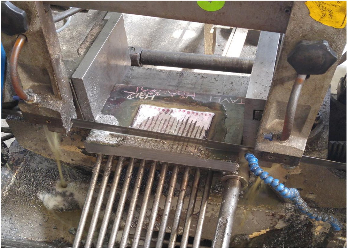
Şekil 7.22 İki nolu plakadan makro inceleme numunesi elde edilmesi
