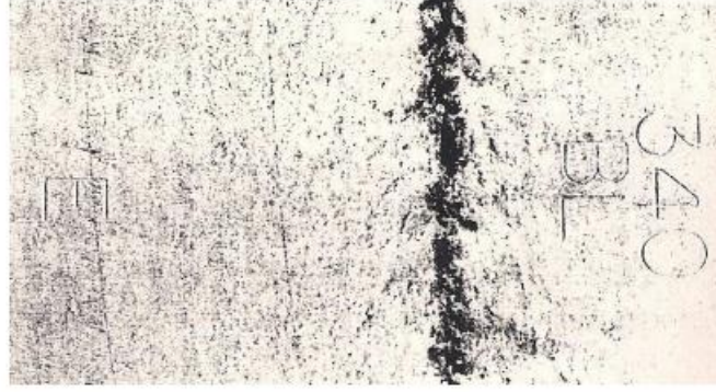
Şekil 6.2 Sürekli dökümle üretilmiş AISI 1045 çeliğinin boyuna kesitinin sıcak asit dağlaması ile açığa çıkarılan makro yapısı [13]
