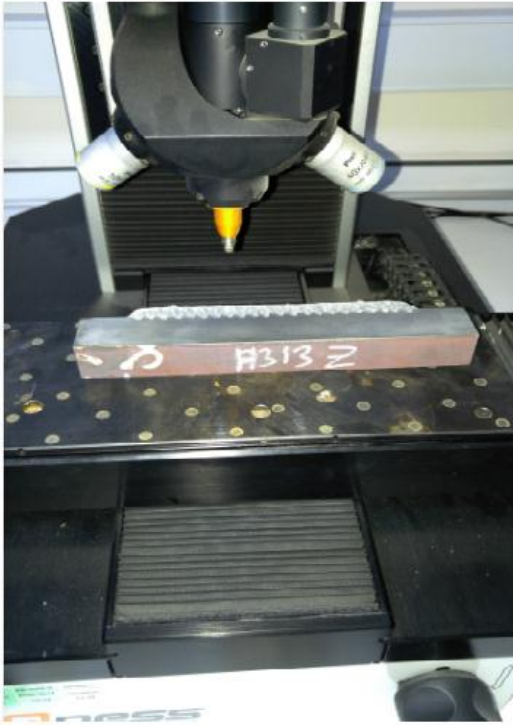
Şekil 7.26 Universal sertlik cihazı
