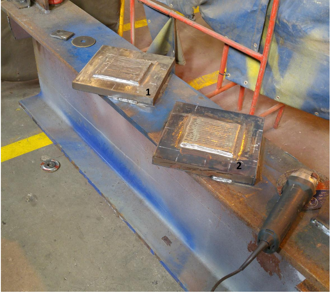
Şekil 7.19 İşlem sonucu bir ve iki nolu plakaların nihai hali
