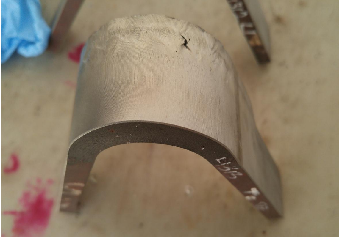
Şekil 7.33 Eğme testi sonucu ön tavsız I nolu numune
