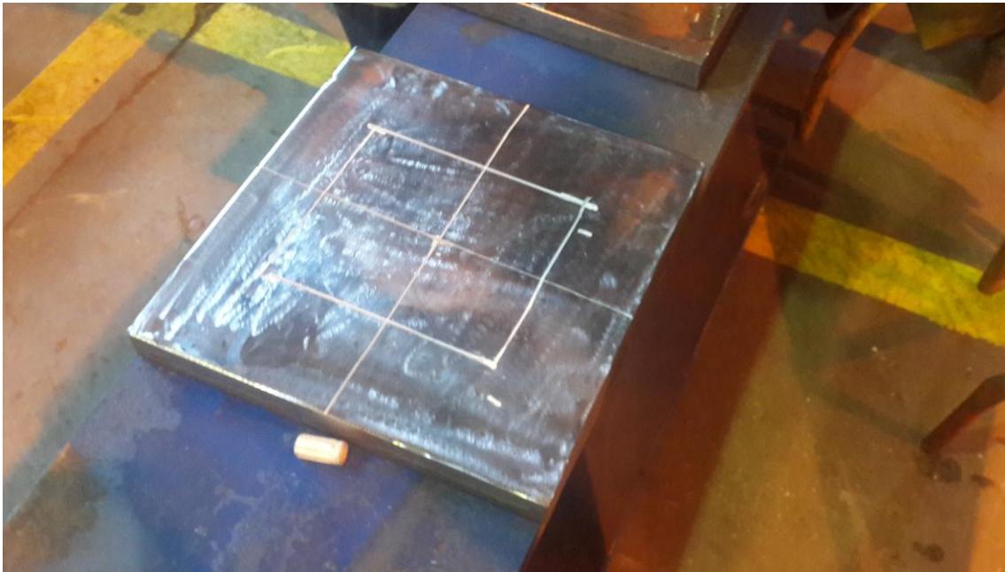
Şekil 7.9 Kaplama yapılacak bölgenin işaretlenmesi II
