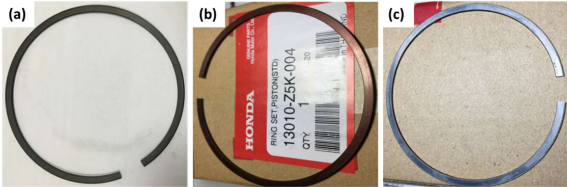
Şekil 3.10 (a) ZnP kaplı segman, (b) Ba kaplı segman ve (c) ZnP kaplaması kaldırılmış segman
