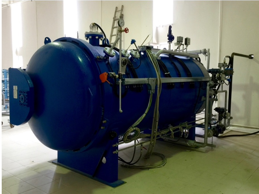
Şekil 2.5 Ø1500 X L3000 mm laboratuvar ölçekli Italmatic marka otoklav
