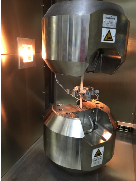
Şekil 2.12 Cam elyaf- PE Prepreg takviye malzemesi çekme testi sırasındaki görüntüler
