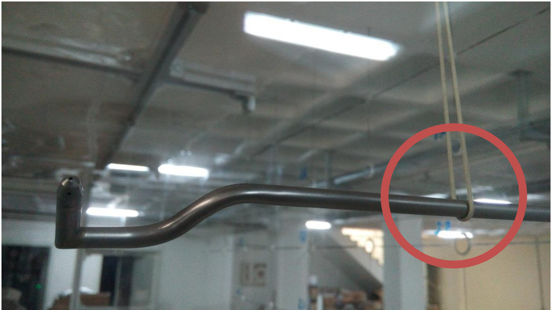
Şekil 4.9 Pitot çubuğunun bir iple askılanarak sabitlenmesi
