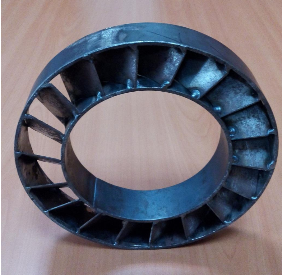
Şekil 4.5 Deneyleerde kullanılan girdap üretici
