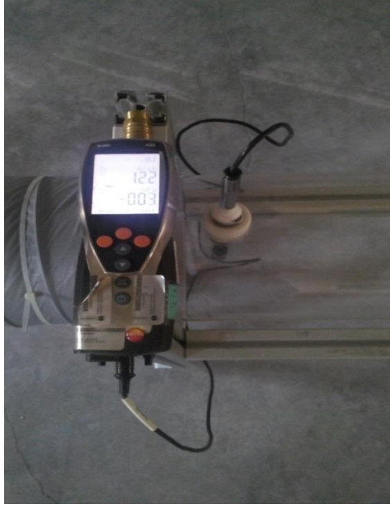
Şekil 4.6 Pervane tip anemometre ile hız ölçümünün yapılması [12]
