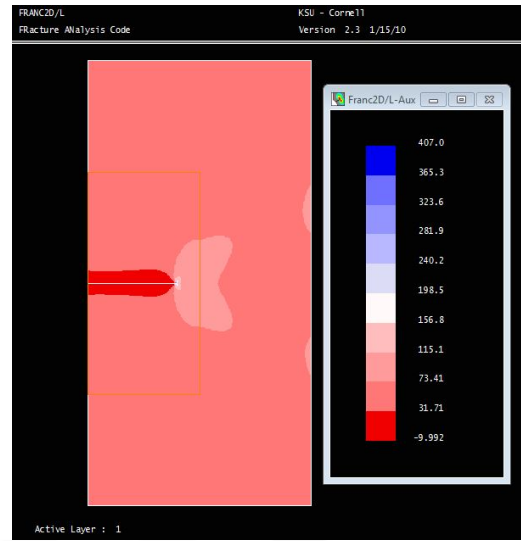
Araldite 2015 Mono Model Çatlaklı Levha \sigma_y Gerilmeleri
