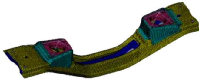
Şekil 3.25 Optimizasyon-1 Tasarımı Sonlu Elemanlar Modeli
