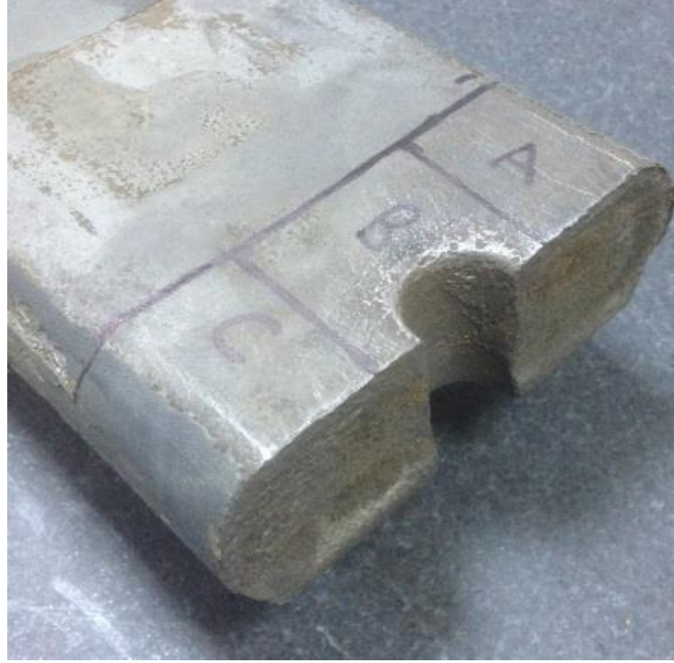
Şekil 8.4 Kırılma kesitinden alınan parçalar
