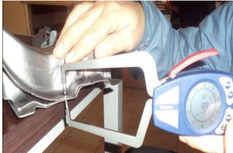
Şekil 3. 23 Saclardaki çökmenin ölçülmesi-2
