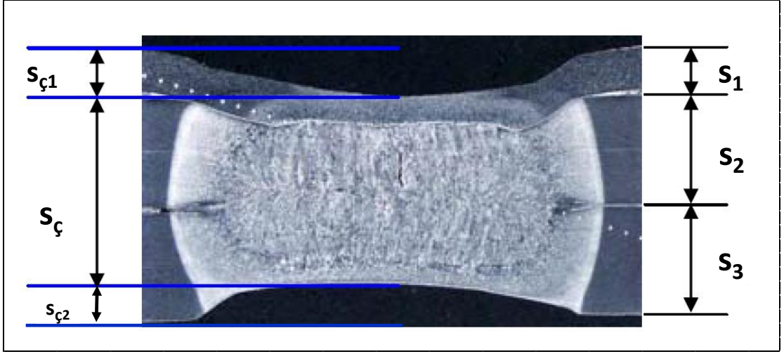
Şekil 3. 21 Punta çekirdeğinde çökme [14]
