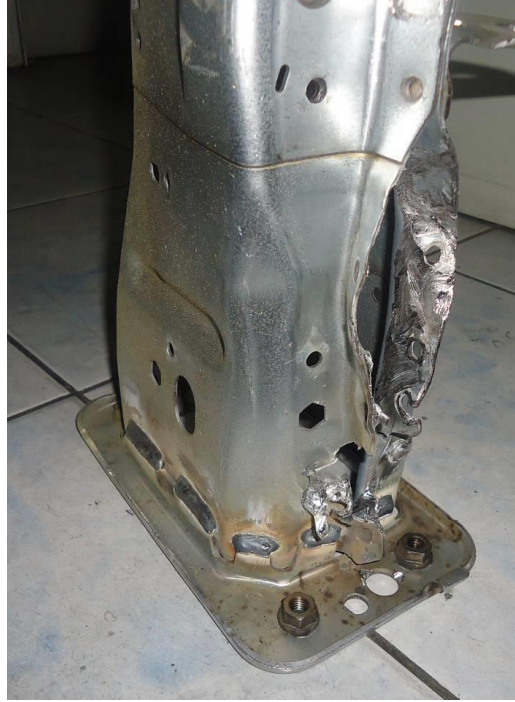
Şekil 3. 24 Teardown yöntemiyle puntaları koparılmış deney parçası
