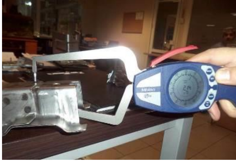
Şekil 3. 22 Saclardaki çökmenin ölçülmesi-1
