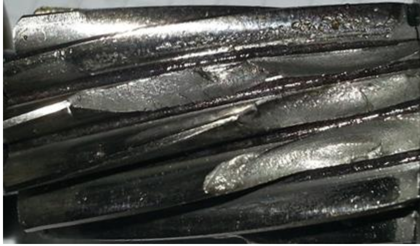
Şekil 4. 19 Beşinci deney sonucunda numune dişlide oluşan yan yüzey basıncı sonucu pitting hasarı
