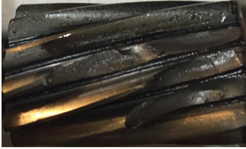
Şekil 4. 16 Dördüncü deney sonucunda numune dişlide oluşan yan yüzey basıncı sonucu piting hasarı
