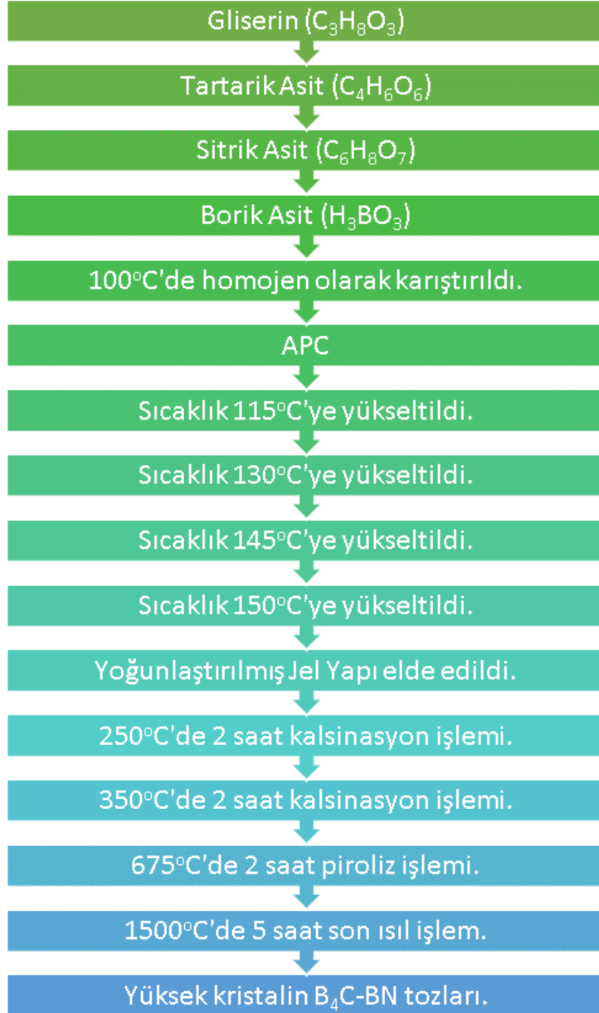
Şekil 2.3 APC katkılı numunenin 4 saat kalsinasyon ve 2 saatlik piroliz işlemi şeması
