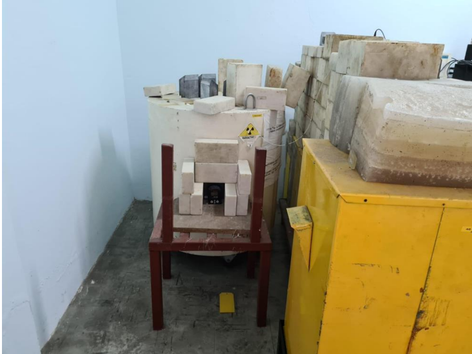
Şekil 2.12 Nötron absorblama performansı ölçüm düzeneği
