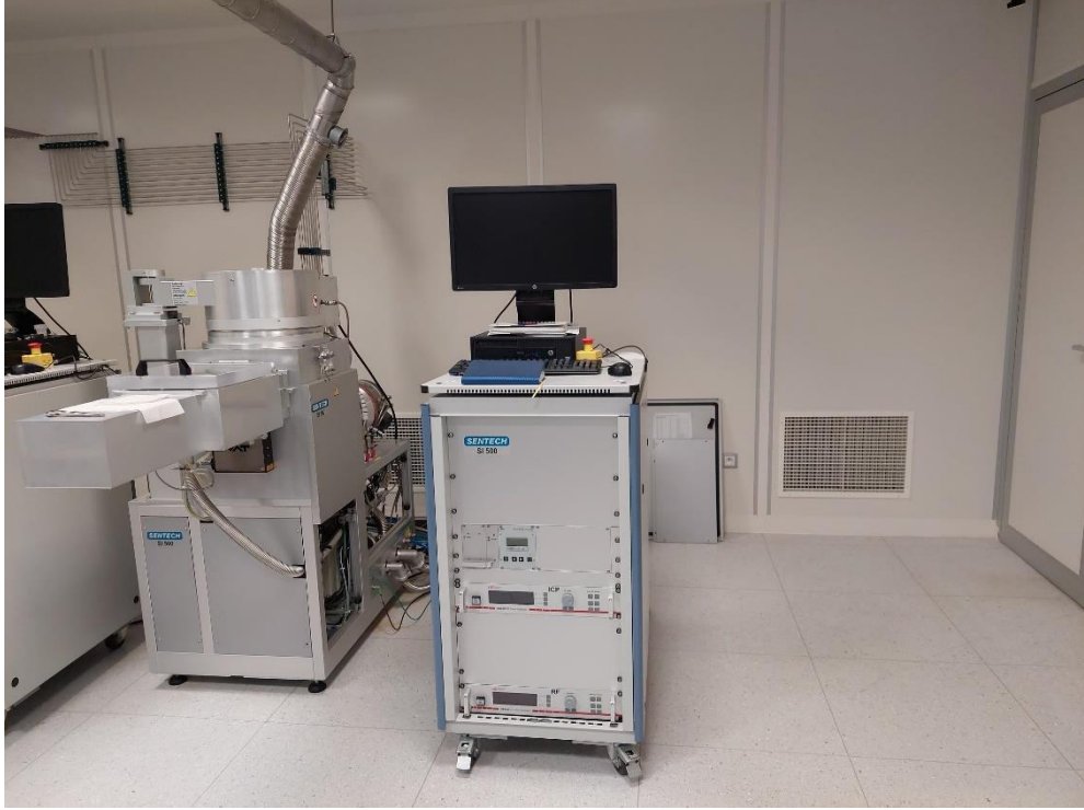
Şekil 3.11 Sentech SI 500 ICP-RIE kuru aşındırma sistemi
