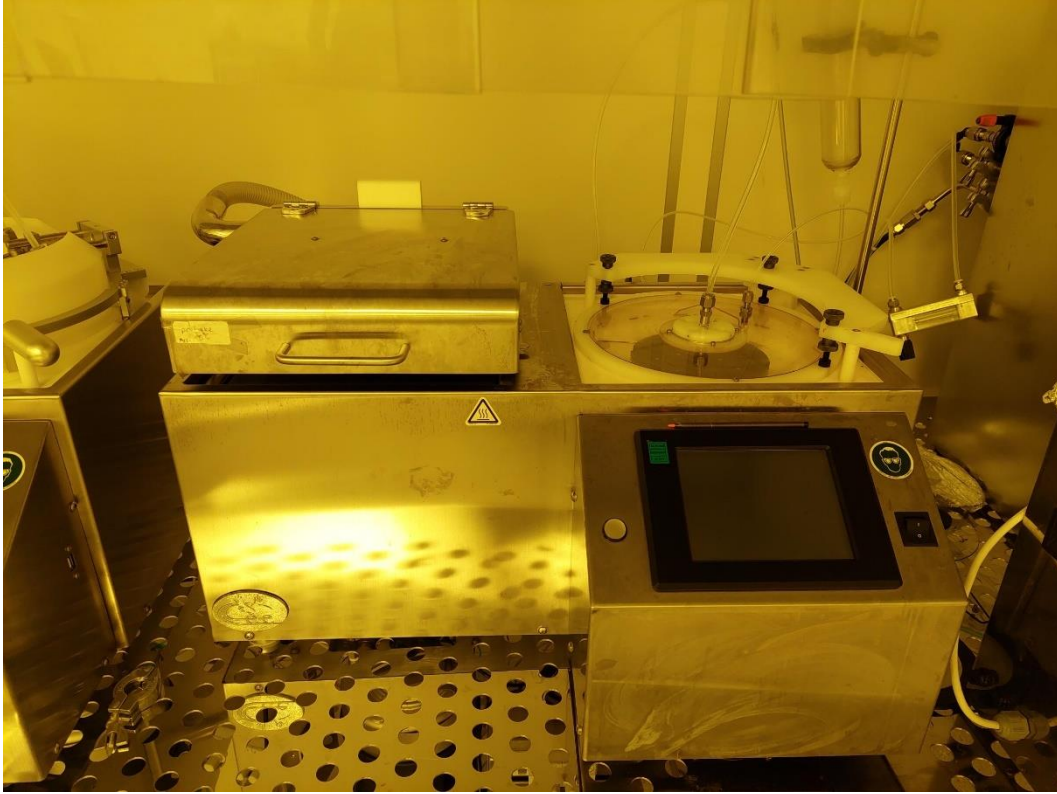
Şekil 3.9 CEE Brewer Science 200CBX marka ısıt ocak
