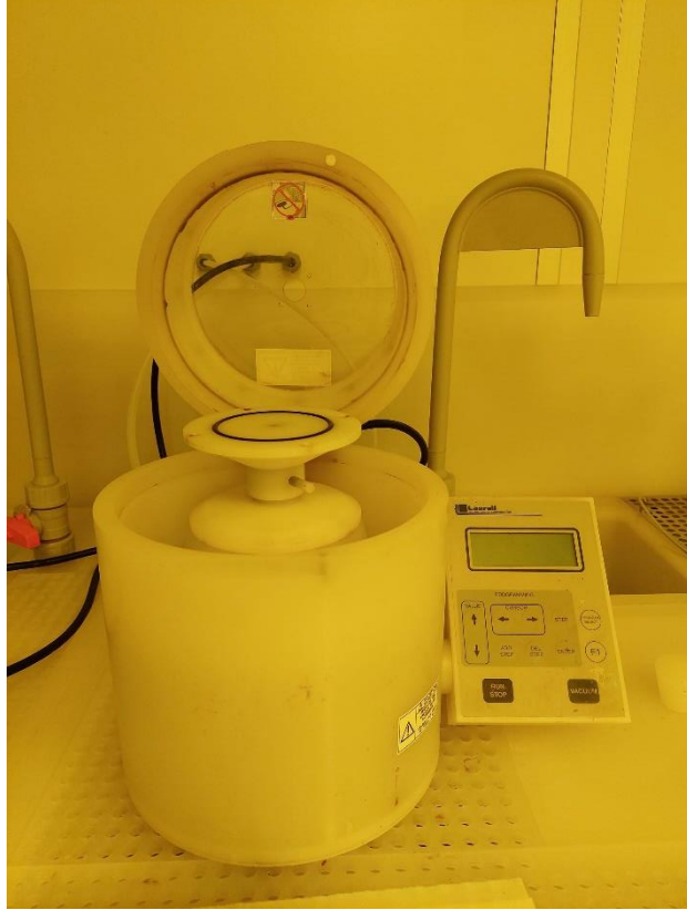
Şekil 3.8 Laurell dönel fotodirenç kaplayıcı sistemi
