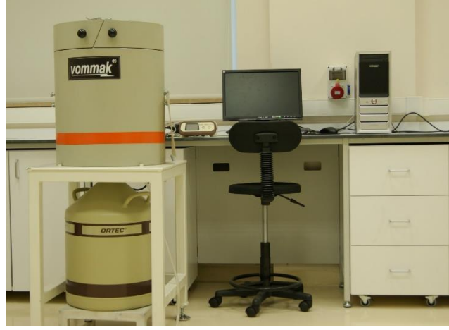
Şekil 4.17 ORTEC, GEM50P4-83 Model yüksek saflıkta germanyum dedektörü [138]
