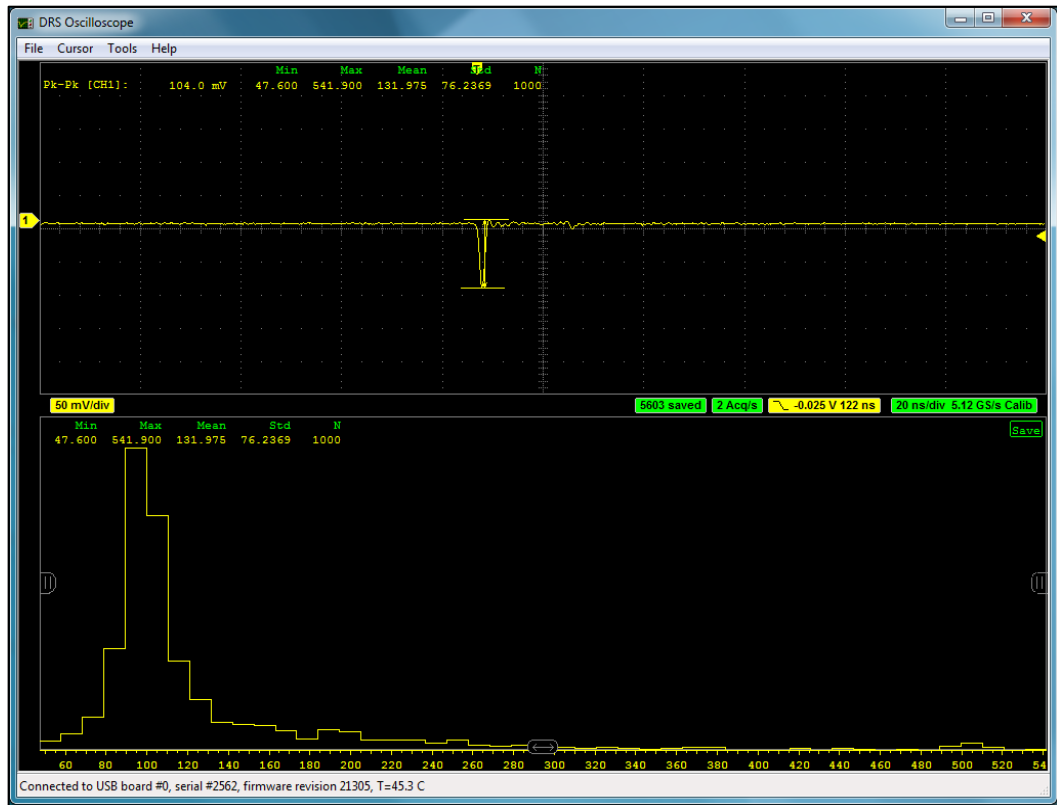
Şekil 3.14 DRS4 Ekran Çıktısı - Kaynak ölçümü (Beta)
