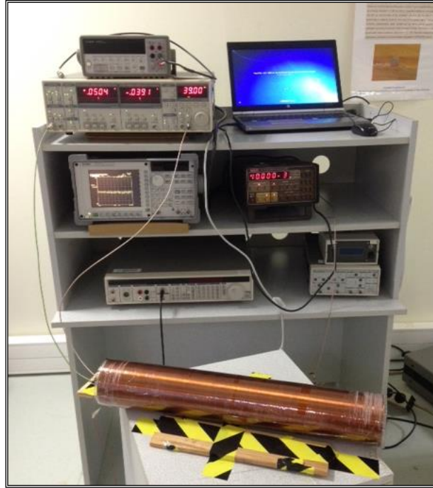
Şekil 3.4 Fluxgate sensör analiz ve karakterizasyon çalışmaları için gerekli deneysel düzenek
