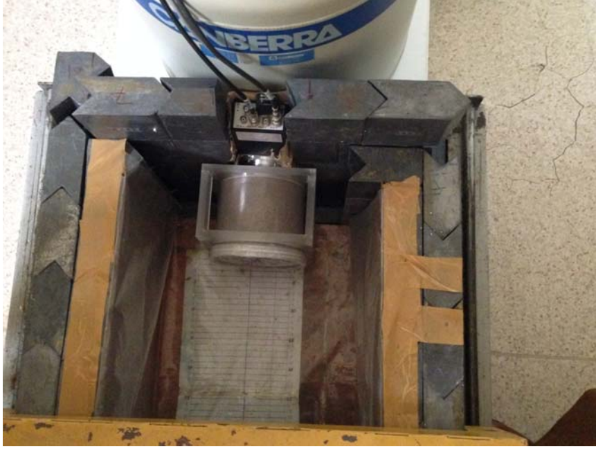
Şekil 4.14 Kurşun zırhla kaplı HPGe dedektör
