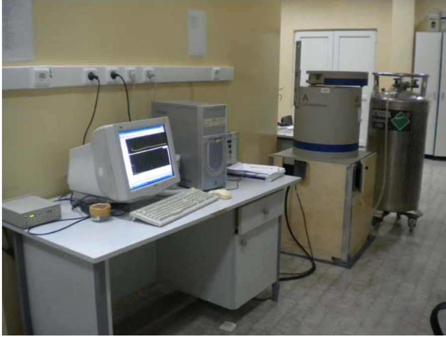
Şekil 4.13 Gama spektrometrik analiz sistemi düzeneği (ÇNAEM Radyoaktivite Ölçme ve Analiz Birimi Laboratuvarı)
