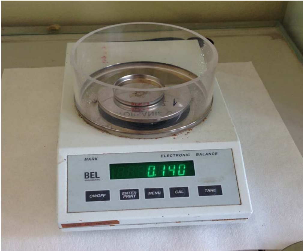
Şekil 4.20 Pudra halindeki öğütülmüş sedimentlerin analizden önce kütle ölçümleri
