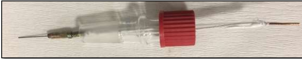
Şekil 3.5 Elektrokimyasal sensör hazırlanması deneylerinde kullanılan kalem ucu grafit elektrot ve elektrot tutacağı
