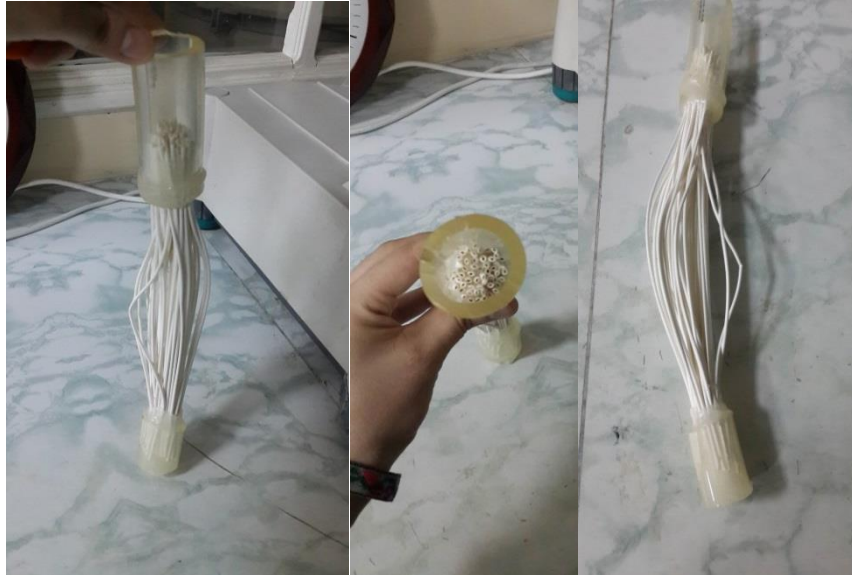
Sıcak silikonla yapılan membran modülü
