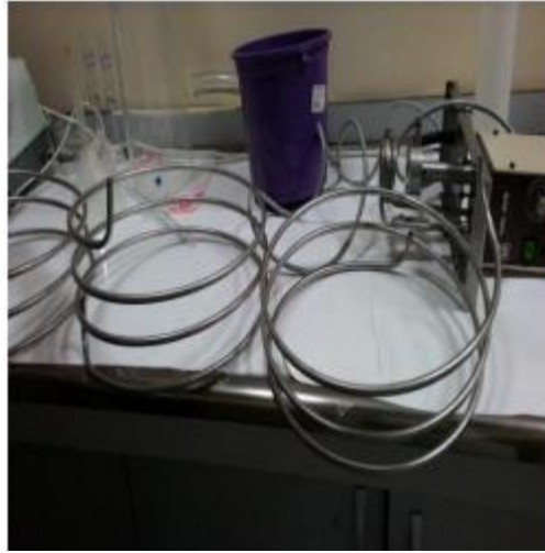
Besleme Tankı içerisindeki metal spiral çubuklar
