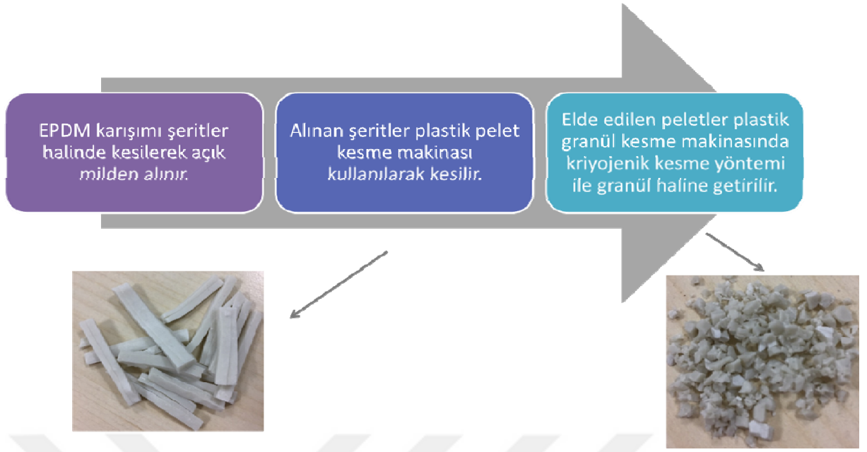
Şekil 8.3 EPDM kompozitinin granül haline getirilmesi
