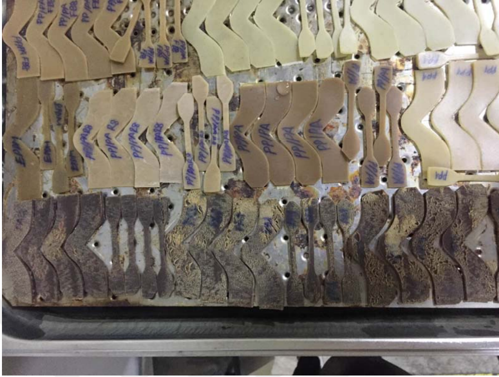
Şekil 9.45 Yaşlandırma sonrası test numunelerin görseli
