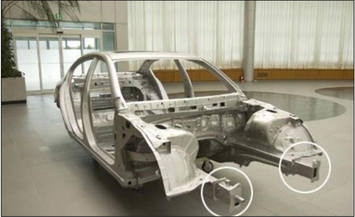
Şekil 1.1 Örnek taşıt şasisi üzerinde çarpışma kutusunun konumu
