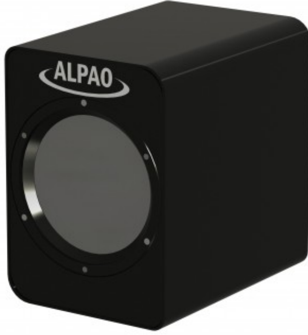
Şekil 3.9 3228 eyleyiciye sahip elektromanyetik sürüslü deforme edilebilir ayna değiştirme miktarı küçüktür.
