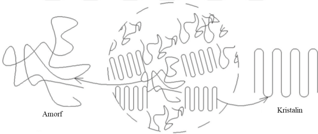
Şekil 2.1 Polimerlerde amorf ve kristal yapı şematik gösterimi [29]
