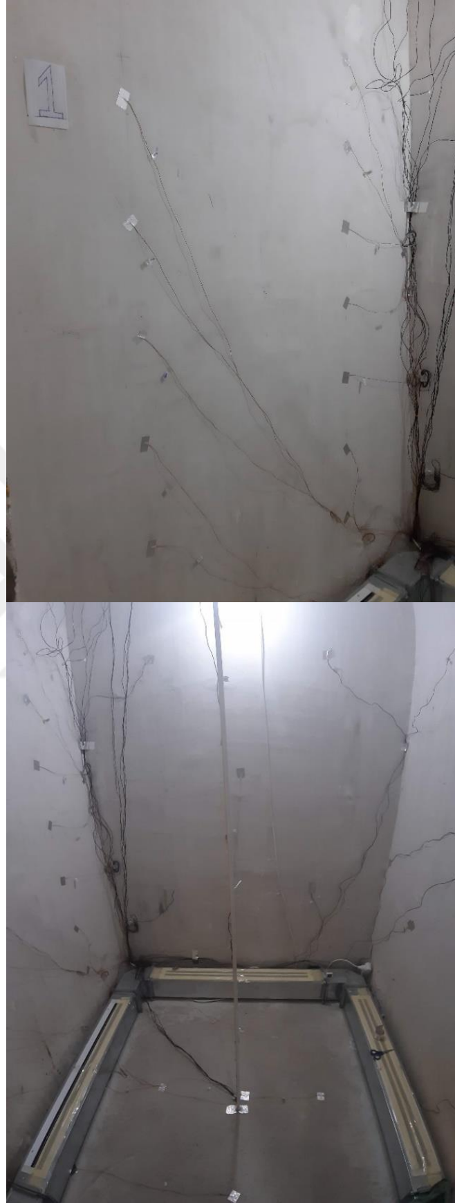
Şekil 3.4 Test odası iç görünüm, Duvar-1 ve deney düzeneğine eklenen süpürgelek hizasındaki hava kanalı
