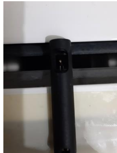
Şekil 3.23 Hava kanalı üzerindeki açıklıktan yapılan hava hızı ölçümü
