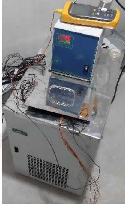
Şekil 3.18 Kalibrasyon su banyosu ve referans sıcaklık ölçer
