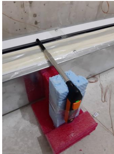
Şekil 3.23 Hava kanalı üzerindeki açıklıktan yapılan hava hızı ölçümü
